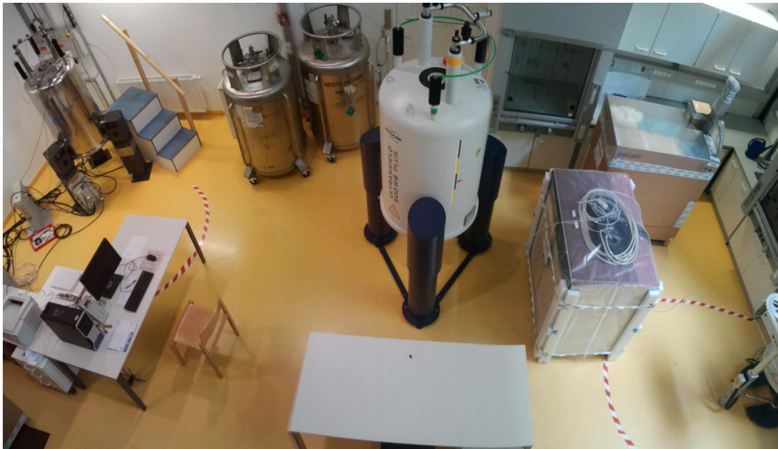
Abbildung 2.2: 500 MHz Spektrometer in Graz. Foto vom 05.09.2012. Der Ultrashield Plus Magnet ist schon vollständig aufgebaut, evakuiert und eingekühlt. Die leeren Heliumkannen sind im Hintergrund zu sehen. Die Konsole und die Palette mit den Probenköpfen und dem Zubehör (rechte Bildhälfte) sind noch originalverpackt. Der PC zur Ansteuerung des Arbeitsplatzes ist noch auf dem Schreibtisch im Vordergrund aufgebaut. Die linke Bildhälfte zeigt ein 500 MHz Flüssig-NMR-Spektrometer mit ungeschirmten Magneten der Firma Oxford.
