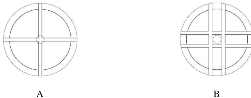
Abb. 183 System von Durchsteckarmen (A) und Doppelkreuzarmen (B), die jeweils in zwei Reihen an der Radwelle fixiert wurden
