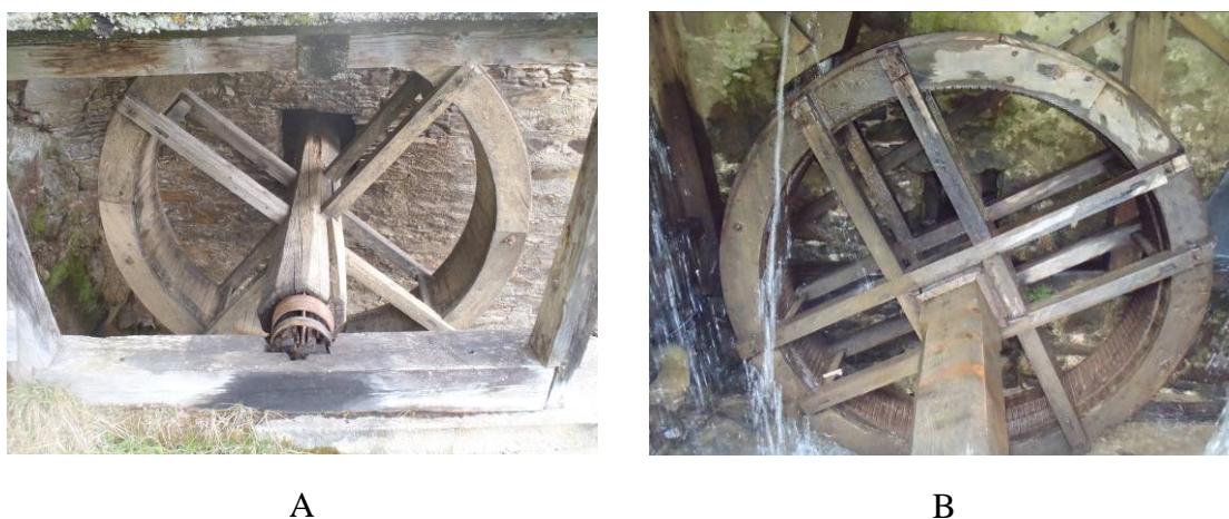
Abb. 184 Vier Arme in zwei Reihen (A) bei der Mühle vlg. Zipfweber (EM 19) sowie Doppelkreuzarme in zwei Reihen (B) bei der "Kötzlmühle", einer erhaltenen ehemaligen Lohnmühle in Feistriz bei St. Peter am Kammersberg, Aufnahmen am 27.4.2012 (A) und 8.6.2012 (B)
