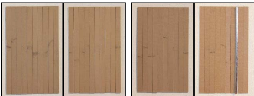
Abbildung 46: Fotos der bei -25 °C geprüften Boardleisten mit 10 mm Distanz; LINKS: Mineralöl; RECHTS: synthetischer Ester
