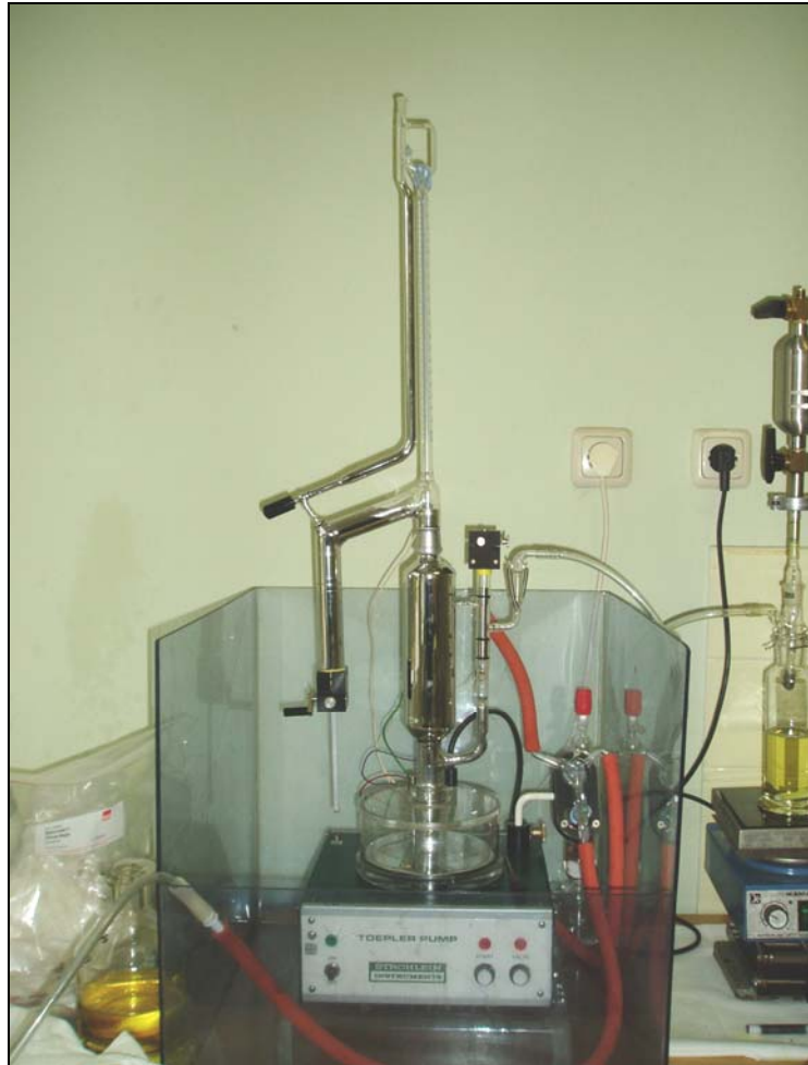
Abbildung 32: Foto der Toepler-Pumpe, die im Öllabor der Verbund-Umwelttechnik GmbH in Sankt Andrä/Kärnten verwendet wird und auch für die Analysen der vorliegenden Arbeit verwendet wurde [46]
