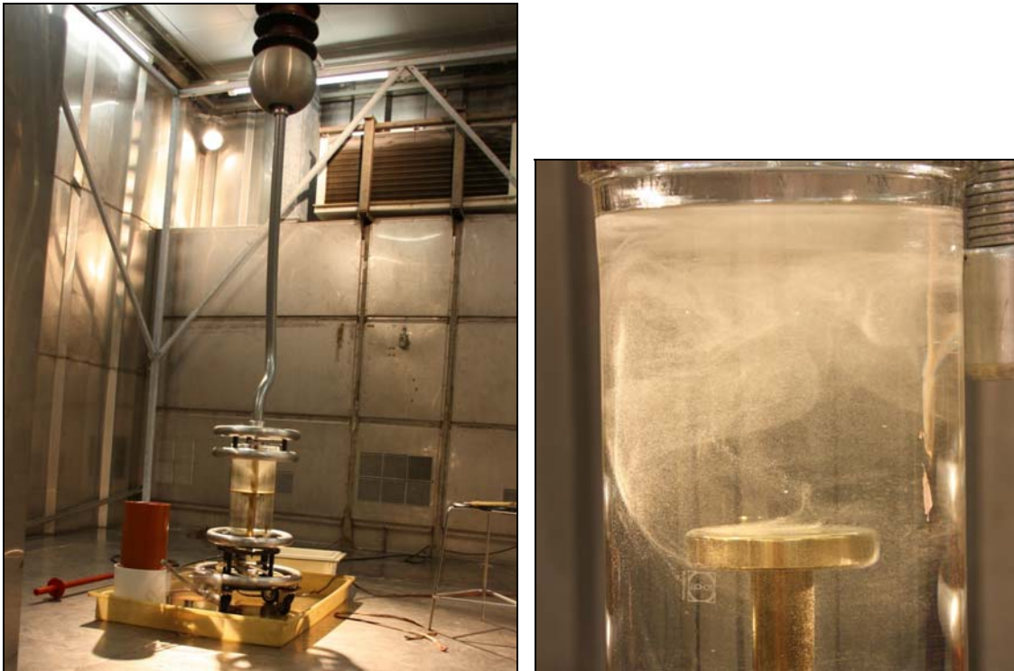
Abbildung 30: LINKS: Kontaktierter Versuchsaufbau im Extremklimaraum (Vorversuche); RECHTS: Foto der starken Bläschenbildung (Vorversuch, -1\text{ }^{\circ}\text{C} , synthetischer Ester)
