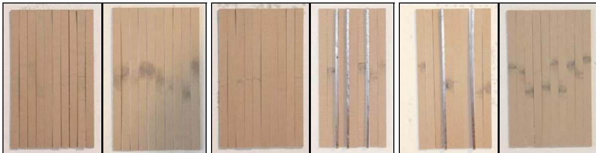
Abbildung 42: Fotos der bei Raumtemperatur geprüften Boardleisten mit 10 mm Distanz; LINKS: Mineralöl; MITTE: synthetischer Ester; RECHTS: natürlicher Ester
