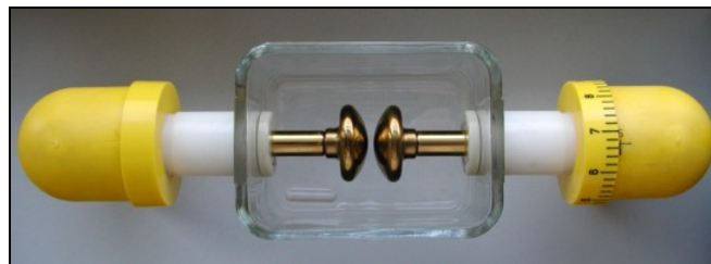
Abbildung 39: Prüftasse nach IEC 60156 mit Elektroden und Rührstäbchen [45]
