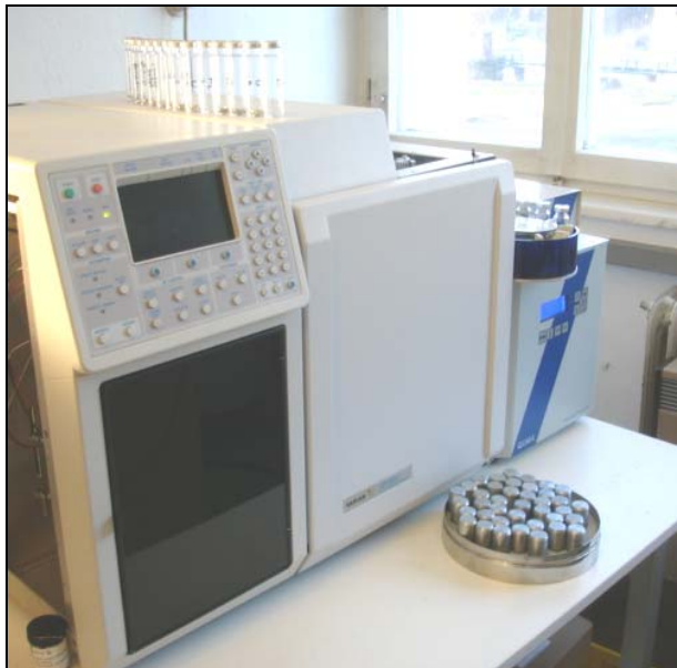
Abbildung 33: LINKS: Bild des Gaschromatographs der Verbund-Umwelttechnik in Sankt Andrä/Kärnten [46]; RECHTS: Nachweisgrenzwerte der detektierten Gase [45]
