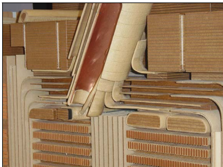
Abbildung 18: Aufbau der Isolierung eines Leistungstransformators [20]
