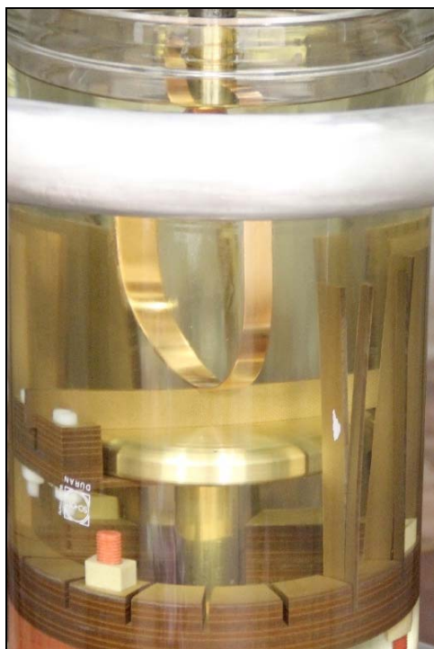
Abbildung 25: LINKS: Die Probenform U-Bügel-Flachleiter unter Öl; RECHTS: Skizze des gesamten Prüfgefäßes (alle Maße in mm) mit eingesetzter Probe und weiteren Proben (senkrecht im Haltering)
