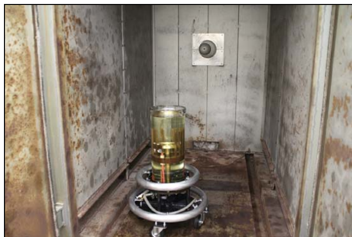
Abbildung 29: Aufstellung des Versuchsgefäßes im Großraumofen zur Erwärmung auf die simulierte Betriebstemperatur
