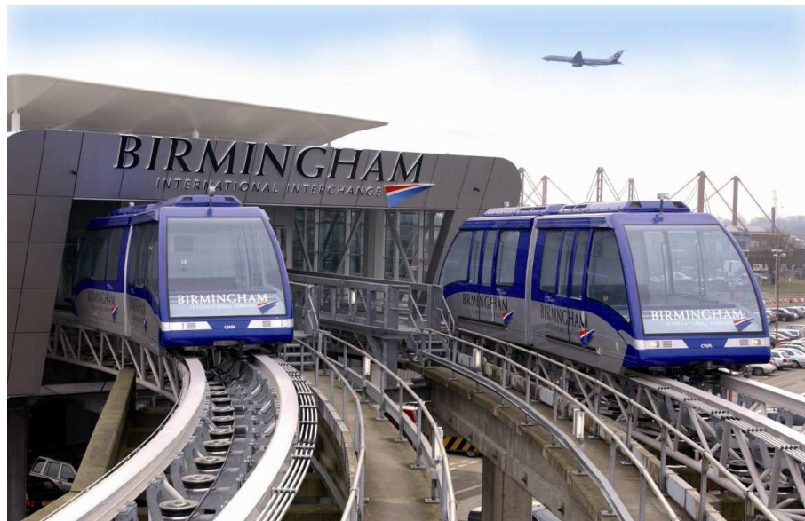
Abb. 1.1: Seilbetriebenes, automatisches Personentransportsystem Air Rail Link am Flughafen Birmingham [2]
