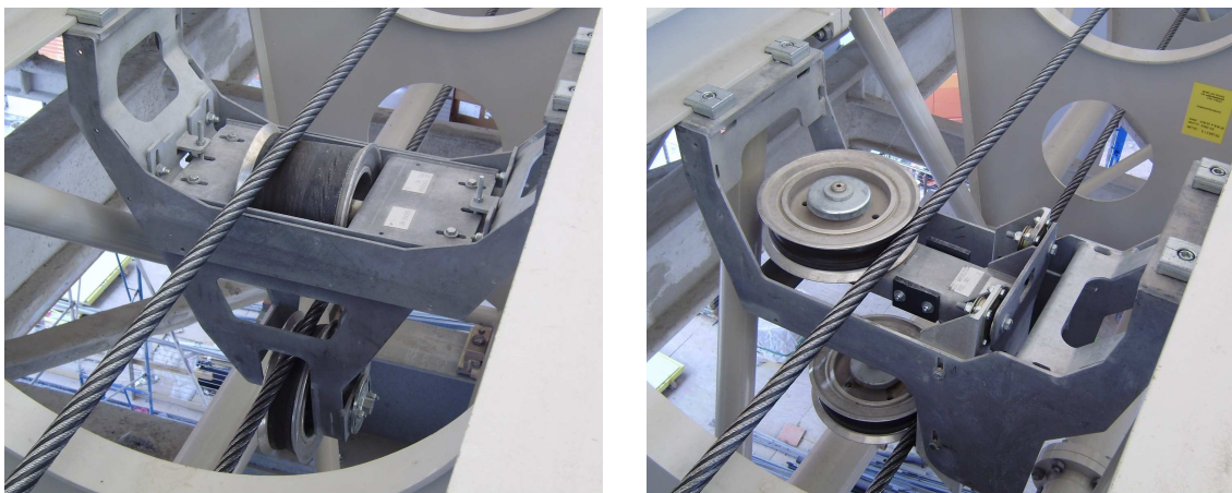
Abb. 1.6: Technische Ausführung der a) Tragrollen und b) Kurvenrollen [5]
