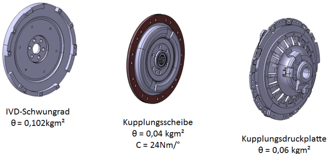
Abbildung 4.16: Massenträgheit und Federsteifigkeit von Kupplungseinheit und Schwungrad
