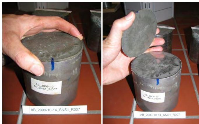
Abbildung 5.21: a) Probekörperunterteil aus Serie SNS1 nach Haftzugprüfung. \zeta_{\text{HZ}} = 4,6 \text{ N/mm}^2 , b) Ablösen der UHPC-Schicht 1 Tag nach HZ-Prüfung, \zeta_{\text{HZ}} \approx 0 \text{ N/mm}^2 .
