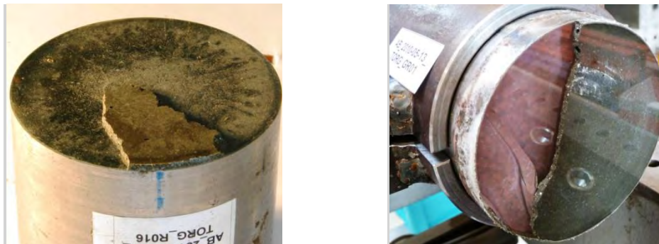
Abbildung 5.74: a) Probe SR0-OVS mit Rissmuster und b) GR0-MVS nach Versuch
