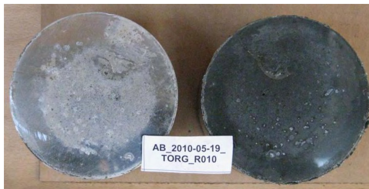
Abbildung 5.22: Bruchfläche einer wiederbefeuchteten Probe
