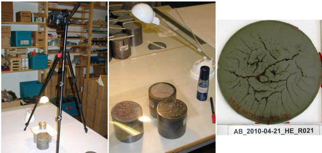
Abbildung 5.27: a) Foto-Set-up für Draufsicht, b) Arbeitsplatz für das Abzeichnen der Rissbilder, c) Risse, die durch Aufspritzen von Ethanol deutlich sichtbar werden
