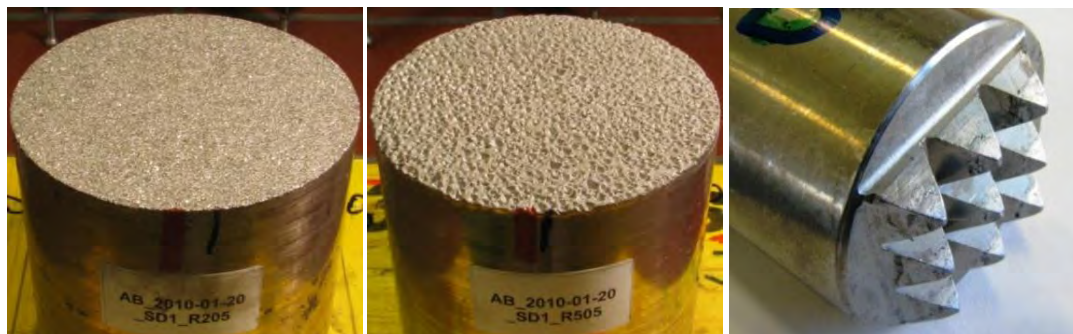
Abbildung 4.19: Stahlproben der Haftzugprüfungen mit den Rauheiten a) SR2, b) SR; c) Hammer-Spitzen zum Erzeugen der groben Rauheiten, Flankenneigung rd. 60°
