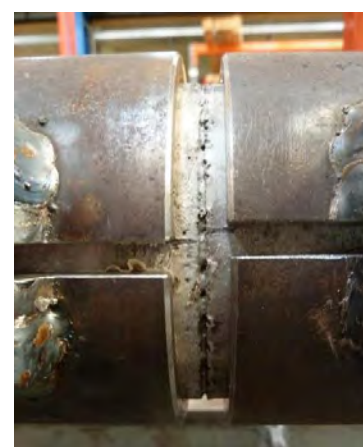
Abbildung 5.67: a) Probeneinbau in Torsionsprüfmaschine und b) freier Bereich zwischen den Einspannungen mit UHPC-Schicht nach dem Einbau
