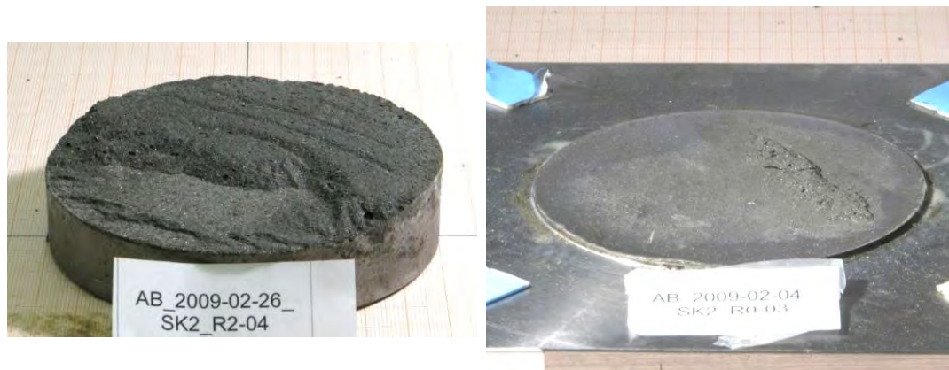
Abbildung 5.52: von Biegeeffekten beeinflusste Bruchformen der Vorserien
