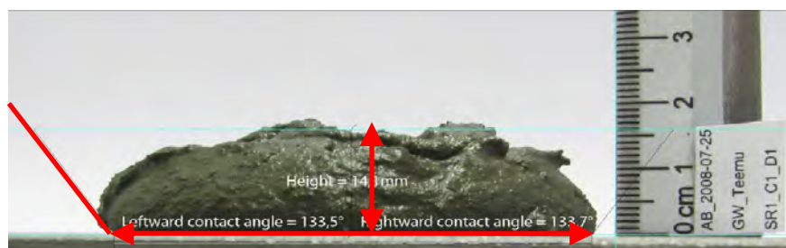
Abbildung 4.13: Ausbreitkuchen, der hinsichtlich seines Randwinkels vermessen wurde
