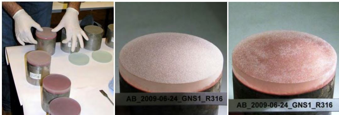
Abbildung 5.2: a) Glas auf Stahladapter kleben, b) vor Ultraschall, c) nach Ultraschall
