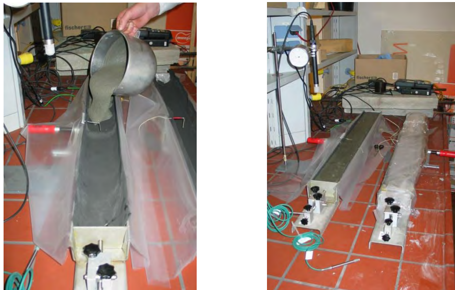
Abbildung 4.7: Schwindrinnenbefüllung und Lagerung
