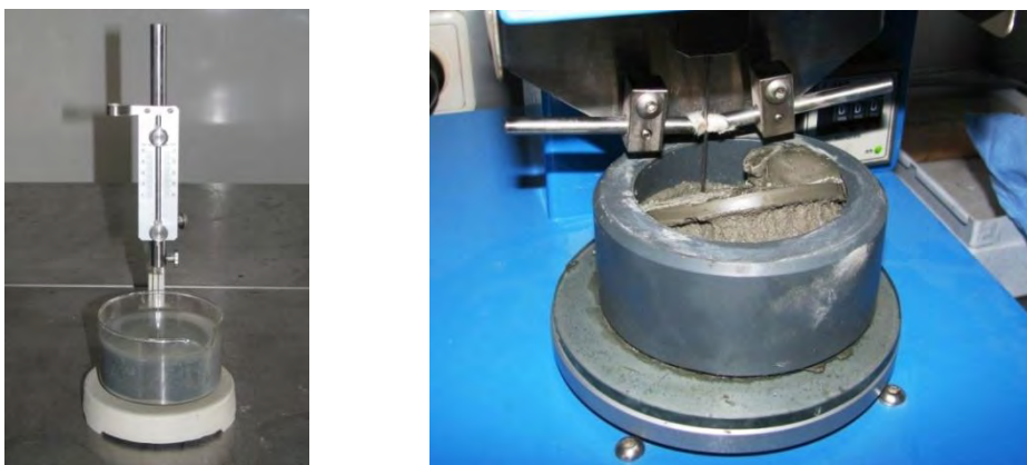
Abbildung 4.8: links: Messung der Nadeleindringung bei wassergelagerter Oberfläche; rechts: Aufschwimmen der angesteiften obersten Schicht bei Lagerung an Luft.
