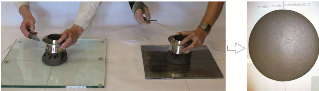
Abbildung 4.14: Ausbreitfließversuch auf glatten Untergründen aus Stahl und Glas
