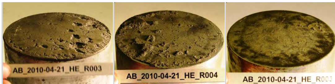
Abbildung 5.45: a) ursprünglich abgelöste Bruchfläche einer 2 d alten Probe, Unterteil, b) zugehöriges Oberteil, c) nachträglich abgelöste Stahloberfläche von a)
