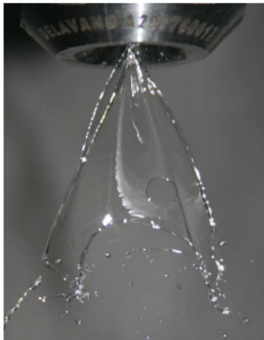
Abbildung 5.30: Bildung einer fächerförmigen Lamelle bei niedriger Reynolds- bzw. Weberzahl der Düsendurchströmung
