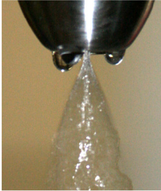
Abbildung 5.43: Zerstäuber Schlick-432, Durchsatz 51 kg/h, Prozessflüssigkeit demineralisiertes Wasser. Eine Lamelle wird ausgebildet.
