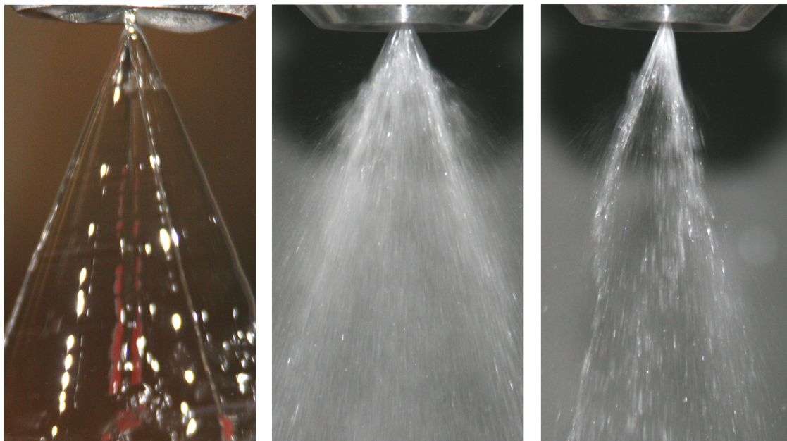
Abbildung 5.32: Betriebszustände der Düsen, bei denen es nicht zur Ausbildung einer kegelförmigen Lamelle am Düsenaustritt kommt. Links: 30 % Luviskol K30 in Masse, Düse SB-60, Durchsatz 109 kg/h; Mitte: 20 % Luviskol K30 in Masse, Düse SD-30, Durchsatz 94 kg/h; Rechts: 10 % Luviskol K30 in Masse, Düse SF-30, Durchsatz 72 kg/h
