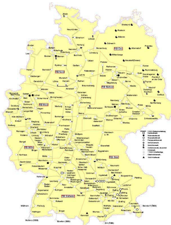
Bild 3-10: 110-kV-Netz der DB und ÖBB. Die Umspannwerke sind immer mit mindestens zwei parallelen Leitungen verbunden
