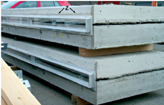
Fig. 6. Dimpled sheet for the discharge of drainage solutions to the mid-pipe of the drainage system (Z, see also Figure 5) Bild 6. Noppenfolie für die Ableitung des Dränagewassers in die mittlere Sammelleitung des Dränagesystems (Z, vgl. Bild 5)
