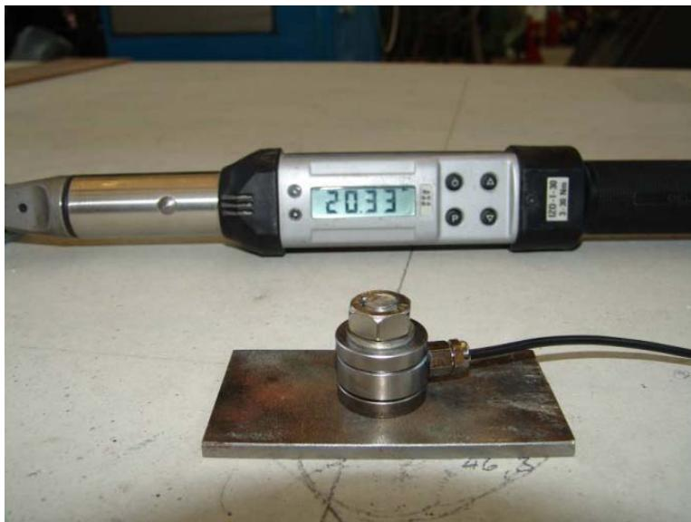
Abbildung 94: Foto Ermittlung Drehmoment erforderliche Vorspannkraft Verankerung
