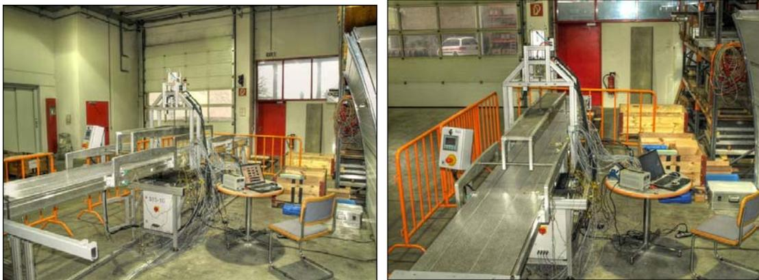
Abbildung 69: Prüfaufbau Ermüdungsversuche am Gesamtsystem
