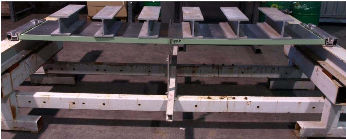
Abb. 5: Belastung der Paneele mit HEB-Träger über Verteilerblech
