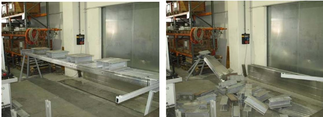
Abbildung 70: Prüfaufbau Ermittlung der Steifigkeiten am Gesamtsystem (Traglastversuch)
