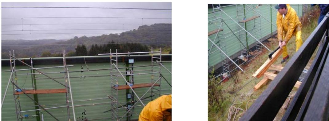
Abbildung 17: Feldmessung – Verformungen und Ausschwingversuche<sup>12</sup>
