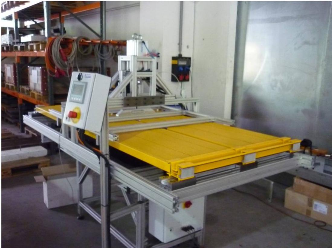
Abbildung 100: Foto Prüfaufbau Ermüdungsversuch Gesamtsystem
