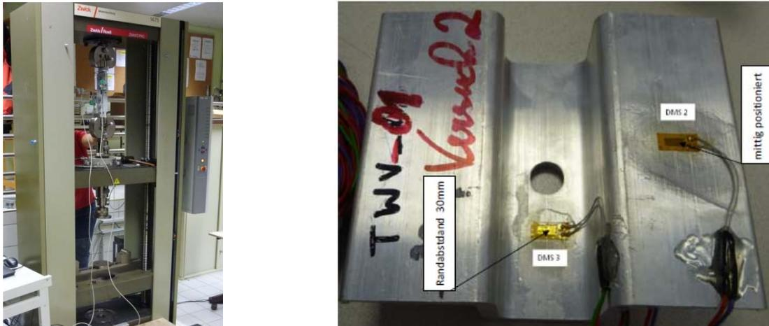
Abbildung 109: Zugmaschine und applizierte DMS auf Verstärkungsteil
