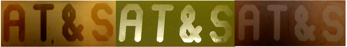
Abbildung 55: Belichtete und entwickelte Lacke auf verschiedenen Substraten: Gold (links), FR4 (Mitte) und Kupfer (rechts).
