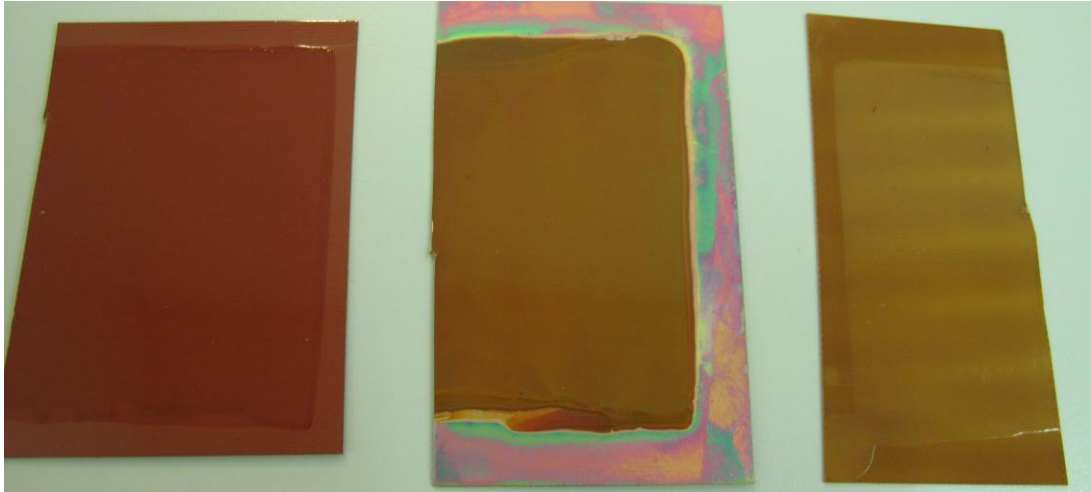
Abbildung 47: Polyimid-, Kupfer- und FR4-Substrate (von links nach rechts) mit \text{pEtOx}_{80}\text{Bu}^-\text{Ox}_{20} -Beschichtung nach 6 Reflow-Zyklen bei 250 °C.
