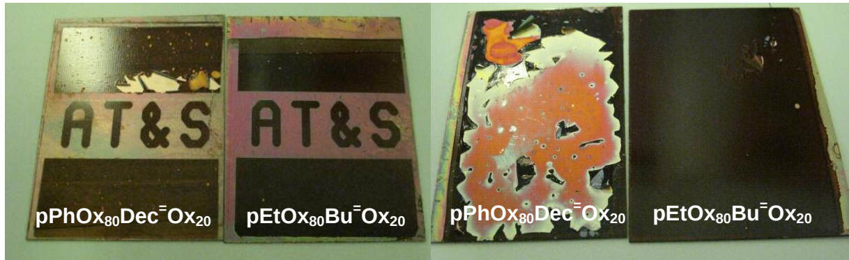
Abbildung 45: Beschichtete OSP-Kupfer-Substrate nach den Reflow-Tests (links: strukturiert, rechts: unstrukturiert).
