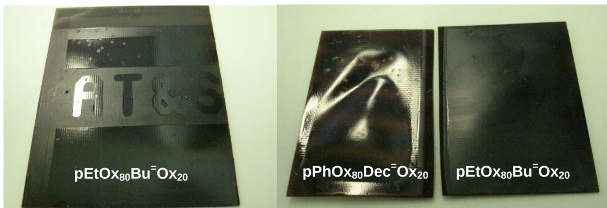
Abbildung 44: Beschichtete FR4-Substrate nach den Reflow-Tests (links: strukturiert, rechts: unstrukturiert).
