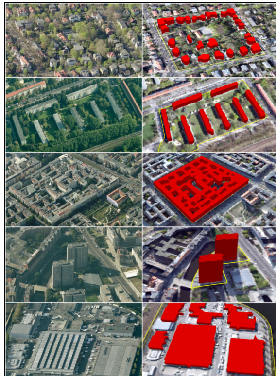
Abbildung 41: Vergleich der fünf unterschiedlichen Gebäudetypen zwischen Schrägluftbildaufnahme (links) und 3D-Gebäudemodell. (Schrägluftbilder: © Microsoft).
