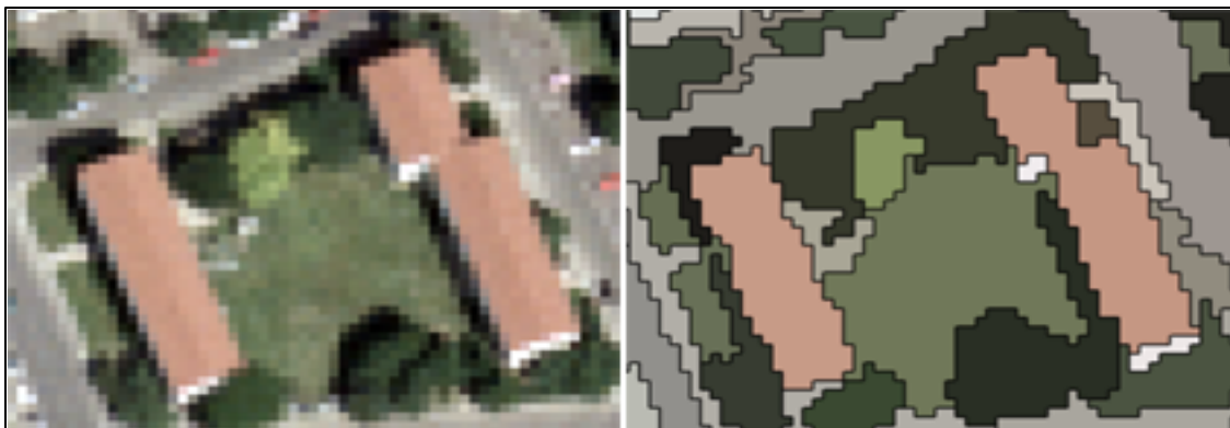
Abbildung 2: Rasterbild (links) und erzeugte Objekte durch Multiresolutionsegmentierung (rechts).
