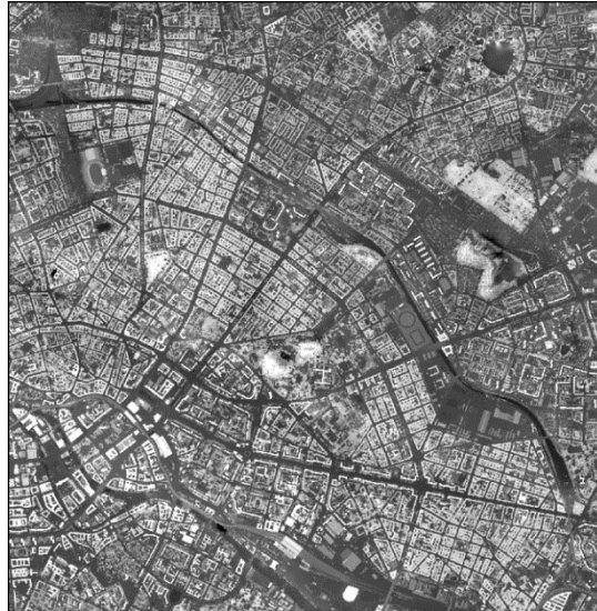
Abbildung 24: Normalisiertes digitales Oberflächenmodell (nDOM).
