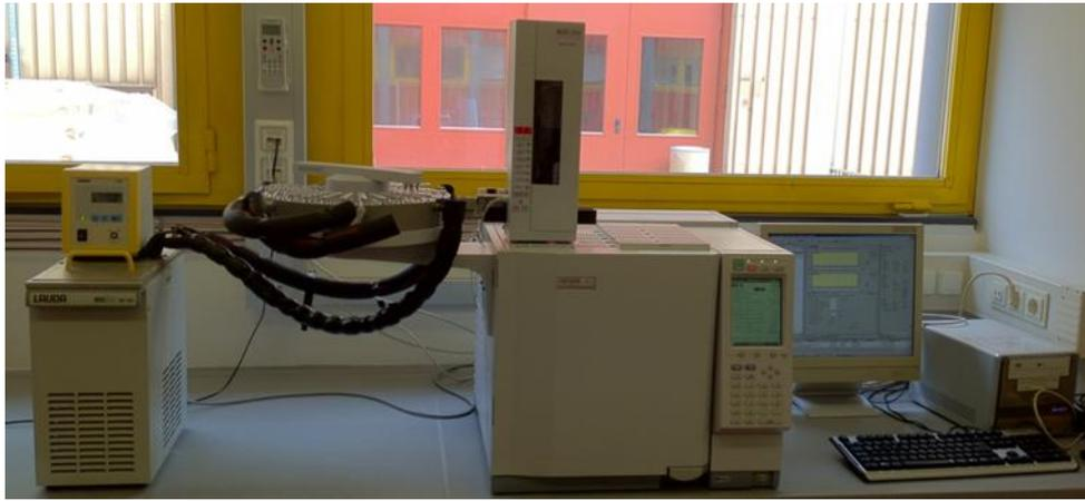
**Abbildung 5-13: GC Shimadzu GC-2010 Plus mit Autosampler AOC-20s, Injektor AOC 20i und Kryostat Lauda ecoline RE 104**
