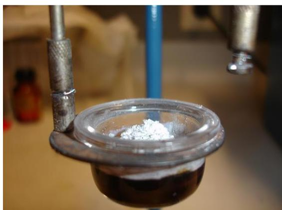
**Abbildung 42:** Siliconöl – selbsthemmende Verbrennung
