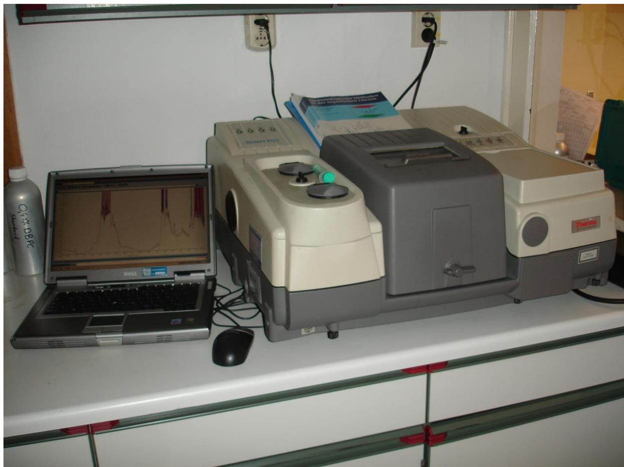
**Abbildung 117:** FTIR Spektrometer Nicolet 5700
