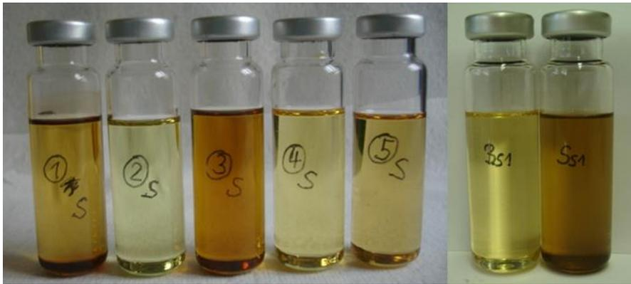
**Abbildung 49:** Aussehen der Isolierflüssigkeiten nach der Behandlung mit Schwefel
