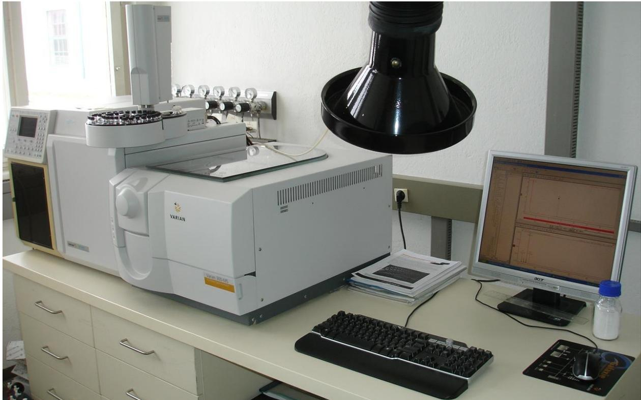
**Abbildung 118:** Gaschromatograph mit Massenspektrometer
