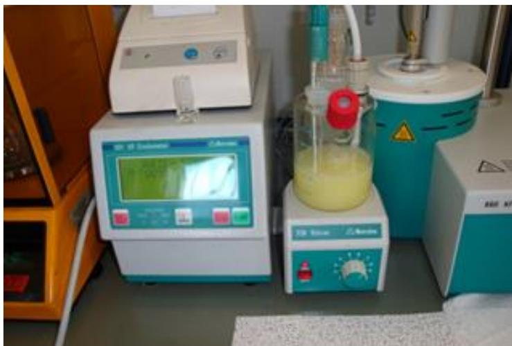
**Abbildung 134:** 831 KF Coulometer gekoppelt mit 860 KF Thermoprep
