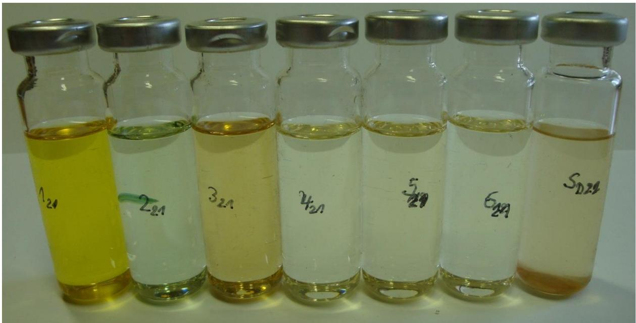
Abbildung 55: Aussehen der Isolierflüssigkeiten nach der Behandlung mit 150 mg/kg DBDS
