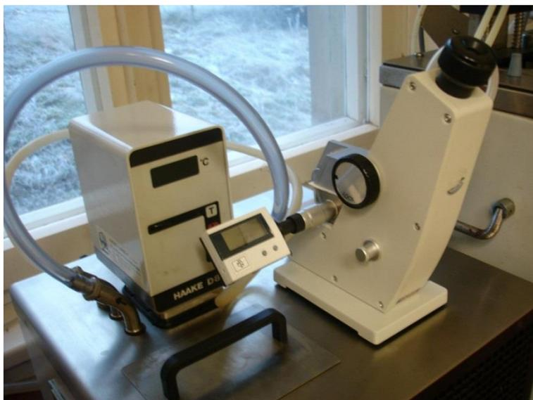
Abbildung 137: Refraktometer Abbe 4
