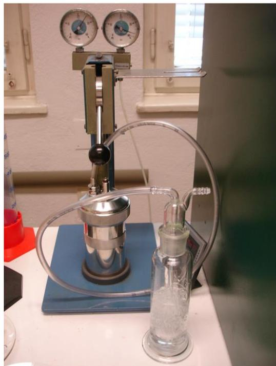
**Abbildung 127:** Absorption der Verbrennungsgase
