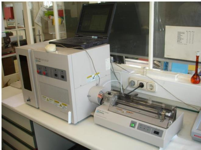
**Abbildung 120:** Mitsubishi TOX - Gerätekonfiguration
