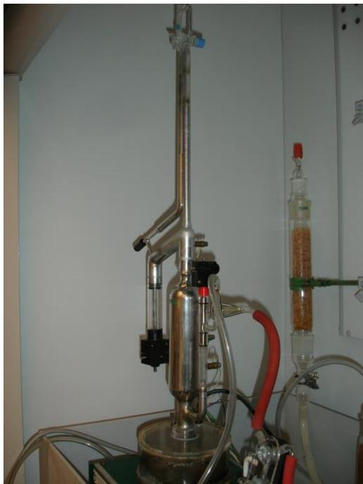
Abbildung 141: Töplerpumpe
