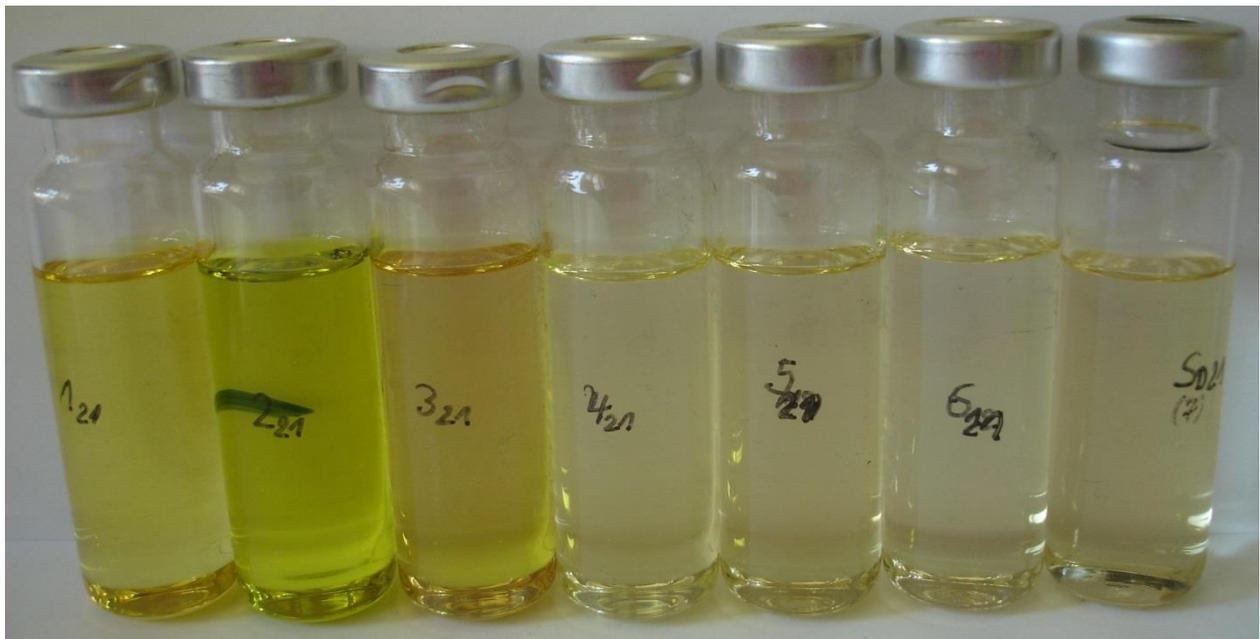
**Abbildung 57:** Aussehen der Isolierflüssigkeiten nach der Behandlung mit 5 mg/kg DBDS
