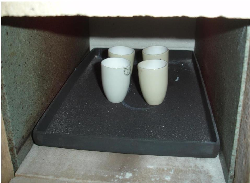
Abbildung 132: Verbrennung im Porzellantiegel – hohe Form
