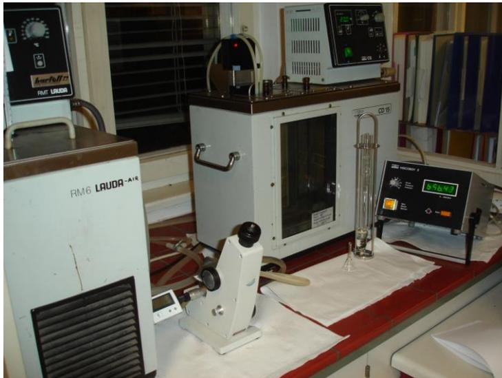
Abbildung 121: Viskosimeter Lauda CSD 15
