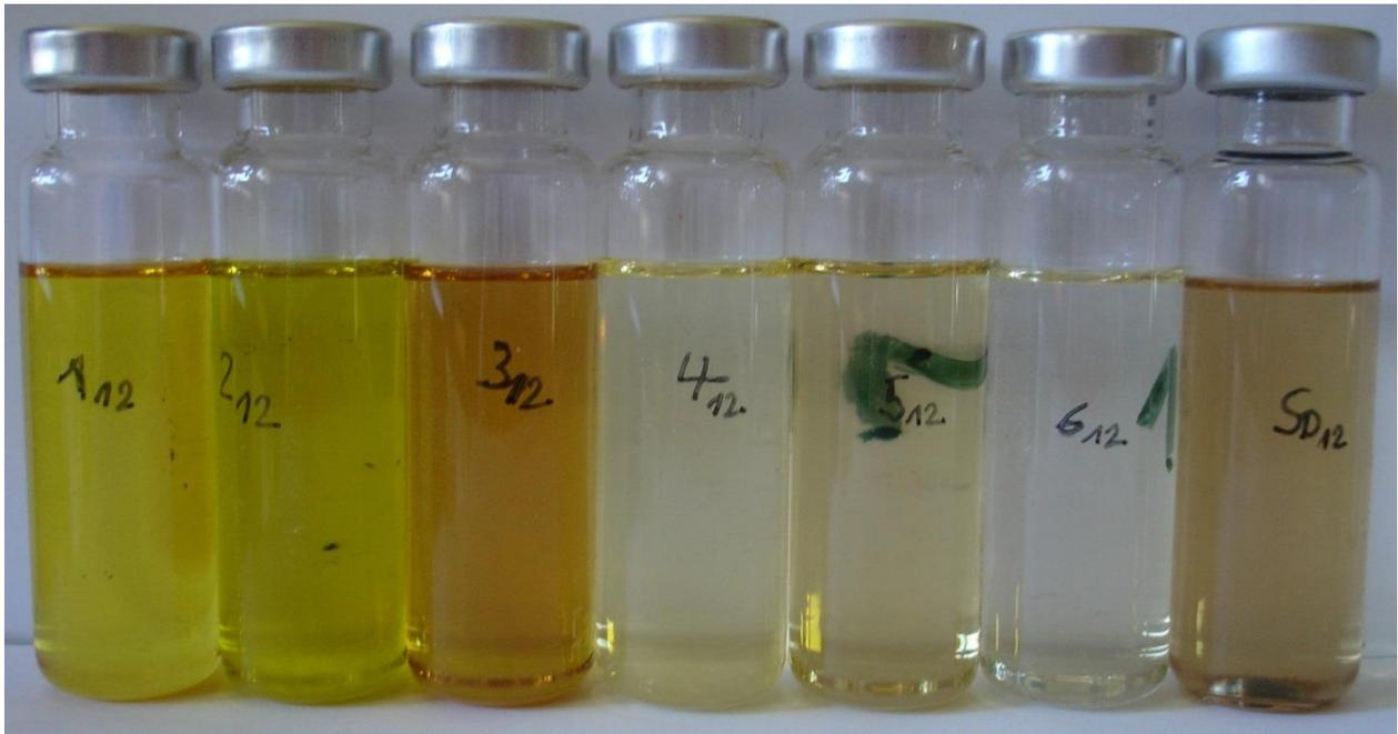
Abbildung 53: Aussehen der Isolierflüssigkeiten nach der Behandlung mit 1050 mg/kg DBDS
