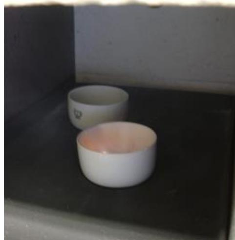
**Abbildung 41:** Siliconöl – Blick in die Muffel bei 400 °C
