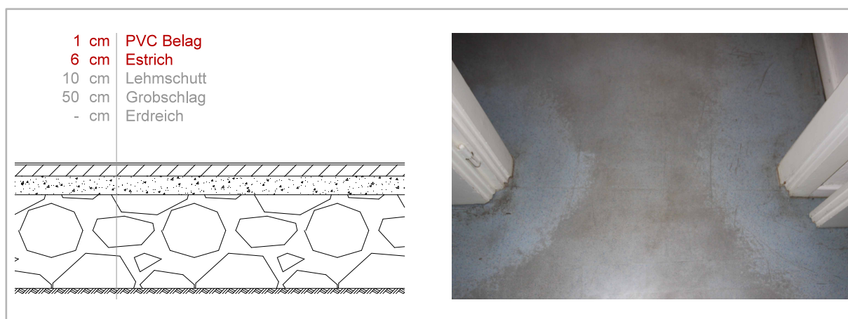
Abbildung 6-23: Darstellung des Fußbodens in den Instituts- und Verwaltungsräumen im Kellergeschoss der Alten Technik wie er heute zu sehen ist
