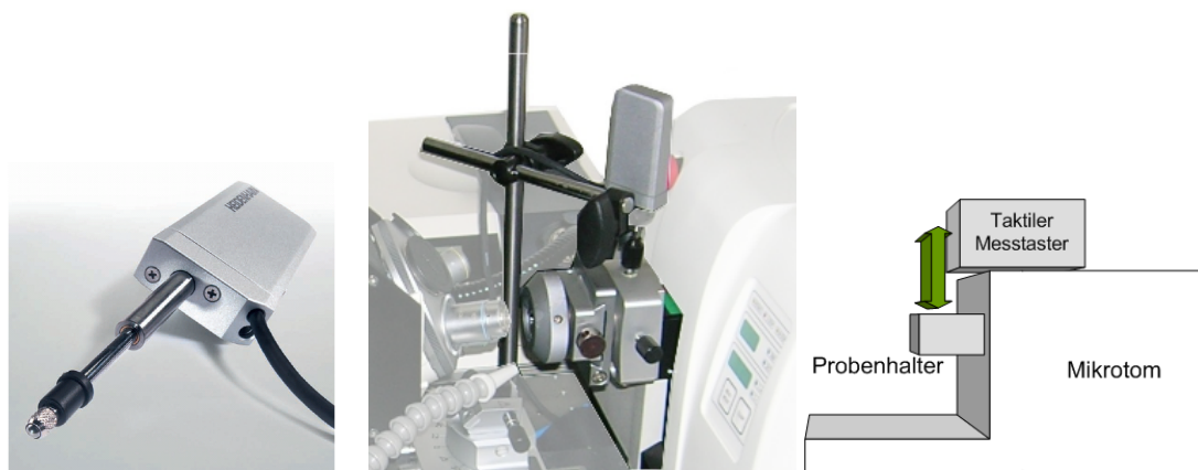
Abb. 3.4. Der Positionssensor zur Messung von Längendifferenzen in den Endstellungen des Probenhalters am Mikrotom. (links) Foto Sensor, (mittig) Positionierung des Sensors am Mikrotom durch ein verstellbares Stativ, (rechts) Funktion Sensor am Mikrotom.
