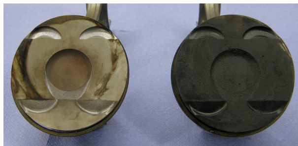
Abbildung 4.44: Kolbenboden normal und verkocht
