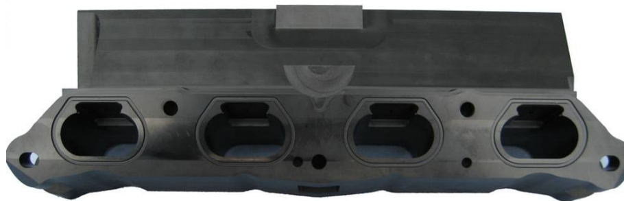
Abbildung 3.13: Kryo-Gemischbildungseinheit aus Terasint
