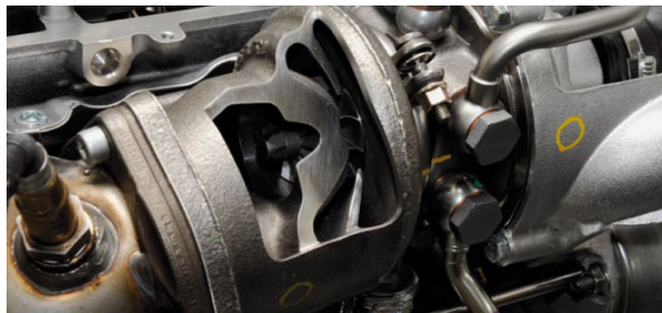
Abbildung 2.9: Schnitt durch das Turbinengehäuse [22]
