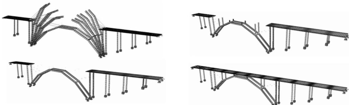
**Bild A 6.3 modellierte Bauzustände**
