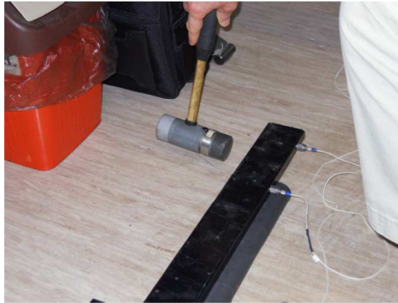
Abbildung 4-5 Messaufbau eines Bump Tests an einem Stator Stab [14]
