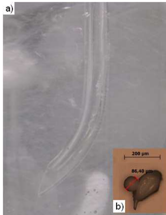
Abbildung 4.21 (a) Tropfendeformation beim Versuch 1 und (b) eine lichtmikroskopische Aufnahme von einem ausgehärteten, deformierten Mikropartikel. Auf der Oberfläche des Rohrs für die Einbringung der Emulsion sind deformierte Öltropfen bzw. durch die Deformation entstandene Polymerfäden sichtbar.
