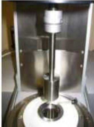
Abbildung 3.8 Anton Paar Physica MCR 301 Viskositätsmessgerät mit der Zylinderspalt-Messgeometrie.
