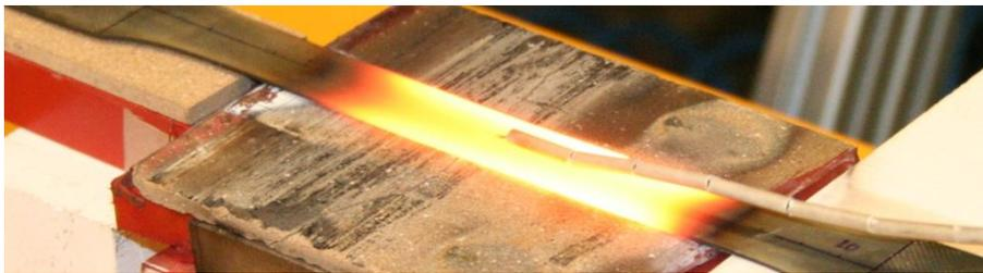
Abbildung 77 Induktive Erwärmung der Flachzugprobe
