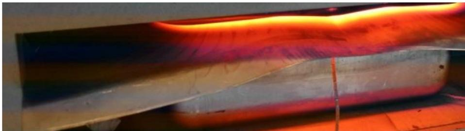
Abbildung 81 Lokale, induktive Erwärmung einer Küchenspüle in einer Längsfeldspule
