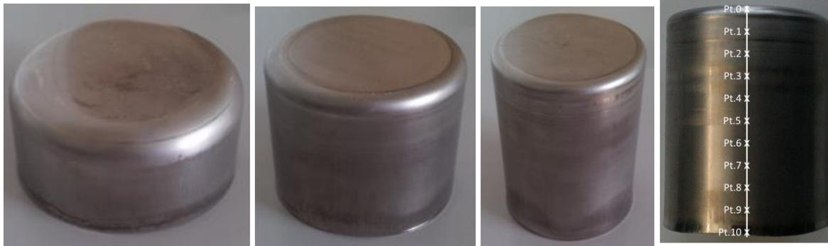
Abbildung 18 Bauteile der einzelnen Ziehstufen: Stufe 1 (links), Stufe 2 (mitte), Stufe 3 (rechts)
