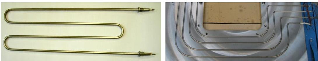
Abbildung 27 Rohrheizkörper (links), Ziehringbeheizung mittels Rohrheizkörpern (rechts)
