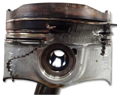
Abb. 4.41: Kolbenschaden am Forschungsmotor nach 80 Betriebsstunden im LSPI-Betriebspunkt (Volllast)
