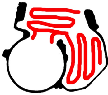
Abbildung 48: Schnitt durch Modulgehäuse mit „Serien-Faltung“
