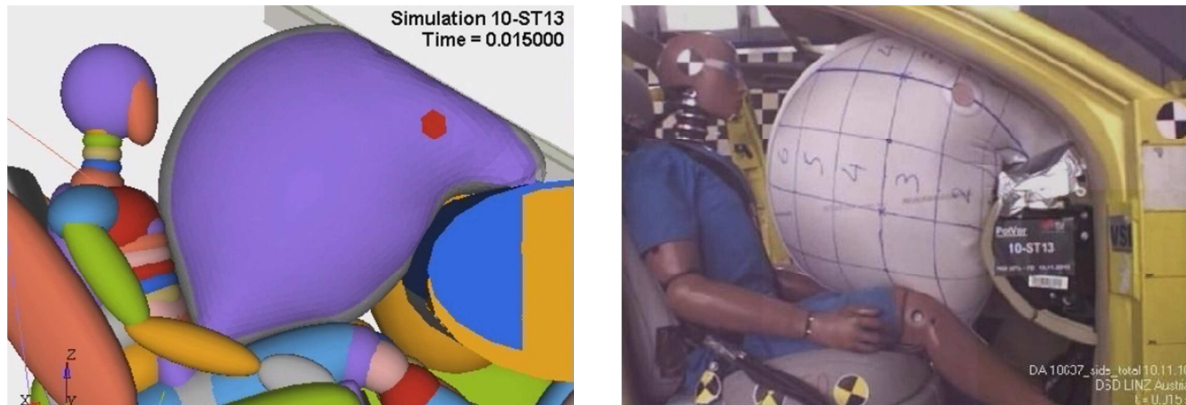
Abbildung 94: Vergleich der Positionierung des Airbags bei Simulation und Versuch (10-ST13)
