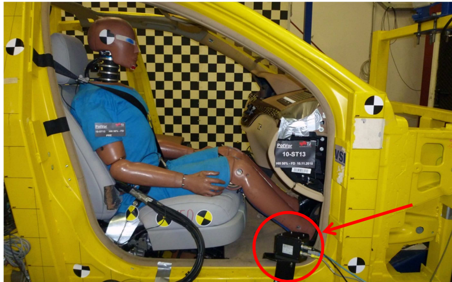
Abbildung 81: Anordnung der Fußraumkamera bei Schlittenversuchen
