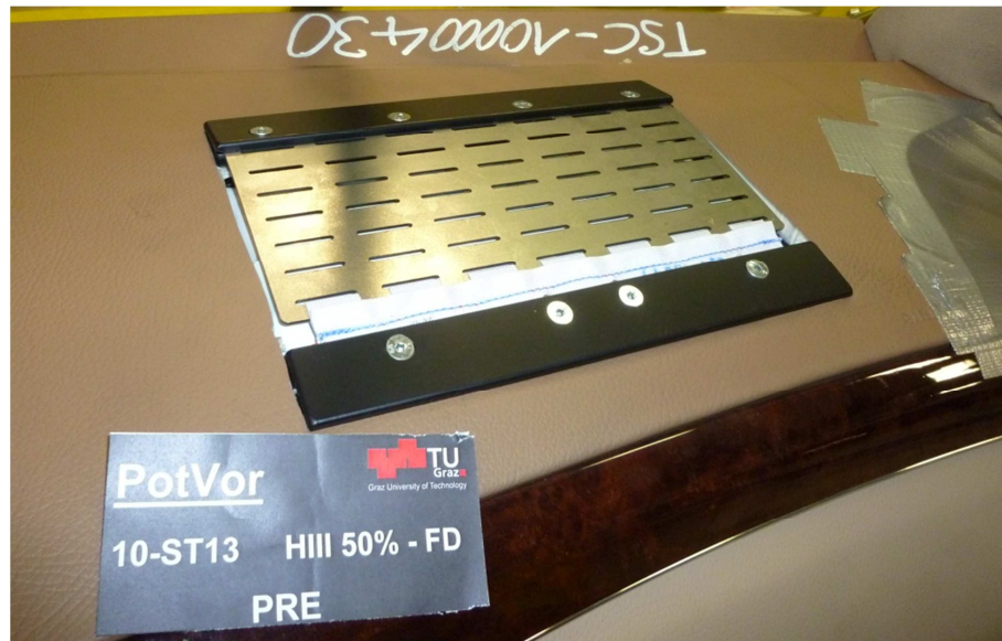
Abbildung 84: Ersatz-Airbagklappe in der Instrumententafel
