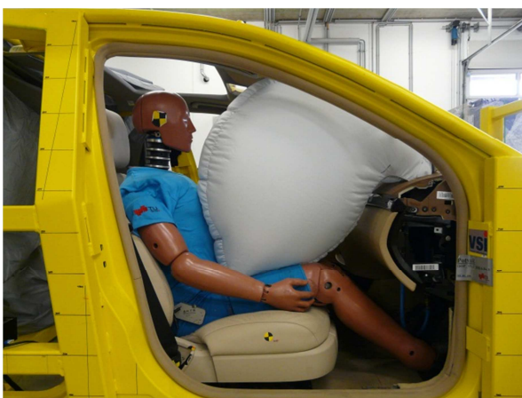
Abbildung 41: Kontrolle der Airbagform in der Simulation, 50%-Dummy
