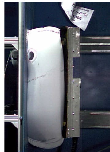
Abbildung 53: HI-Versuch 200ms nach Zündung (Umkehrpunkt des Impaktors)
