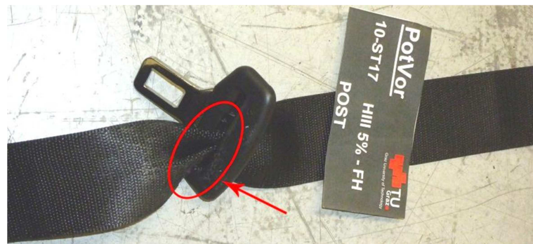
Abbildung 93: Umschlagen des Gurtbandes im Gurtschloss bei den Versuchen mit der 5%-Frau
