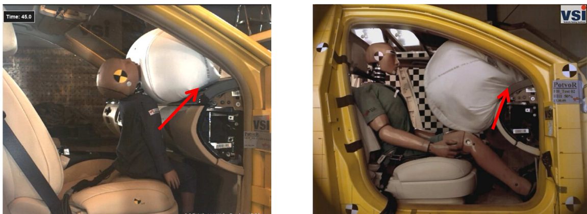
Abbildung 82: Verhängen des Luftsackes beim Austritt aus der IP (links: OoP-Versuch, rechts: Schlittenversuch)
