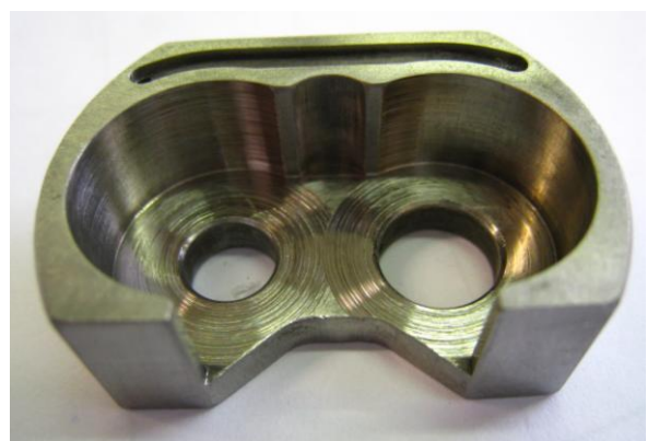
Abbildung 128: Dichtungselement V4.1 mit stirn- und kopfseitigen Einlaufspuren
