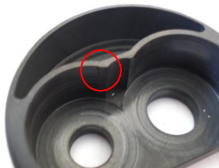
Abbildung 100: Mikro-Einriss im dünnen Steg der Dichtungselement Version V1.3
