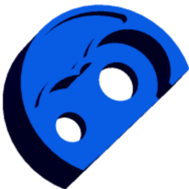
Abbildung 99: Dichtungselement Version V1.2 mit eingefrästem Hohlraum
