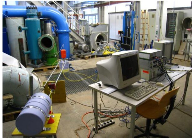
Abbildung 92: Wärmetauscher und Kraftstofftank (linke Seite) sowie Messsystem (rechte Seite)
