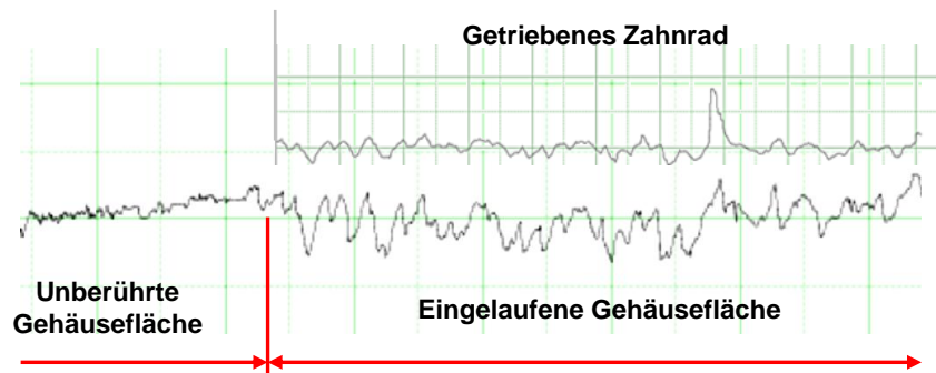
Abbildung 118: Einlaufspuren und Kontur-Messstellen im Gehäuse der Prototypenpumpe
