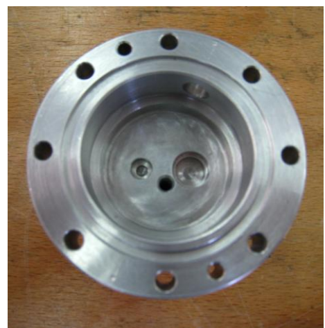
Abbildung 87: Pumpengehäuse mit Lagerbohrungen und Saugöffnung
