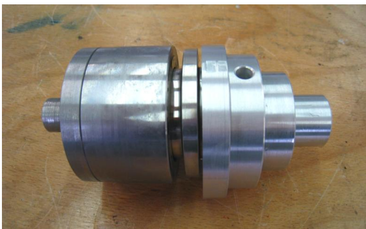
Abbildung 86: Zusammenbau mit Magnetkupplung
