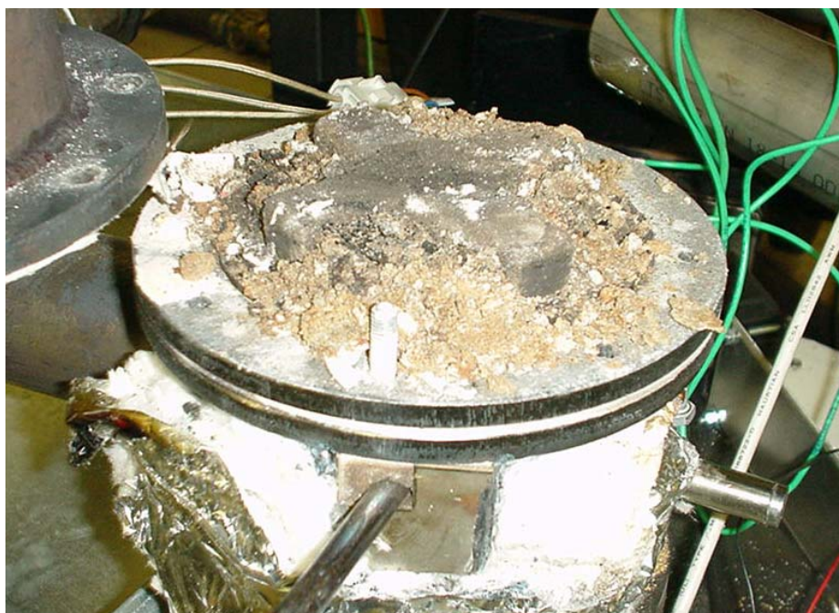
Abbildung 49: Boden des Vergasers mit Primärluftkreuz Erläuterungen: Testlauf vom 19.12.2006; Brennstoff: Weichholzpellets
