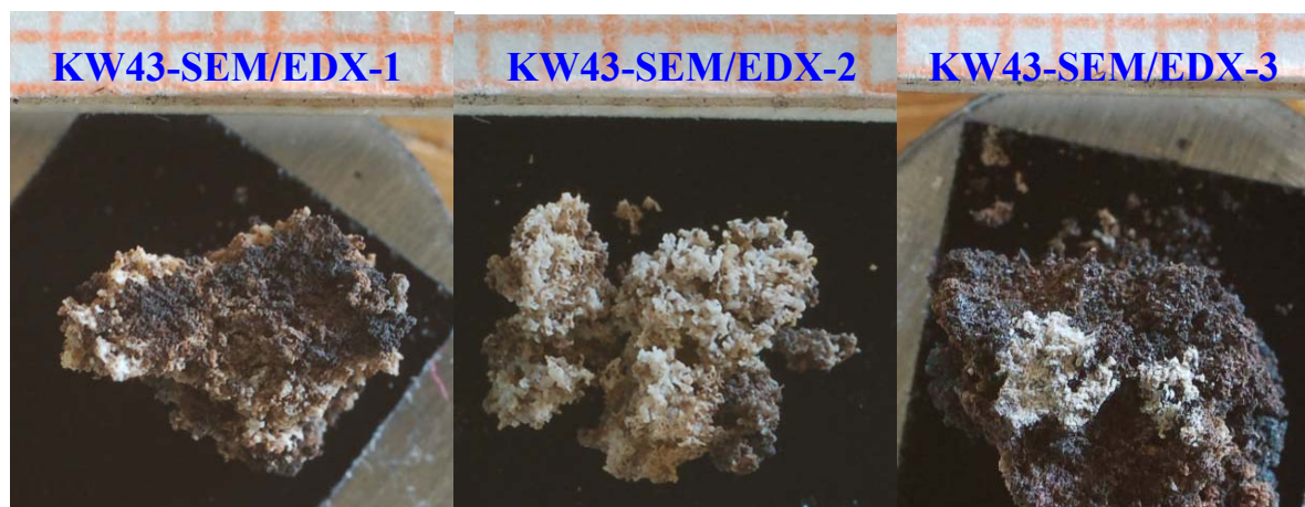
Abbildung 85: Bilder der untersuchten versinterten Ascheproben aus KW43
