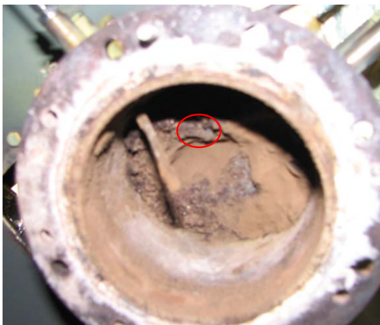
Abbildung 84: Blick in das Vergaserrohr der modifizierten Versuchsanlage 1 von unten Erläuterungen: Testlauf vom 22.10. auf 23.10.2007; Beladung Primärluft: 400g Wasser/Nm 3 Luft; Brennstoff: Weichholzpellets; roter Kreis markiert für Analysen beprobten Bereich
