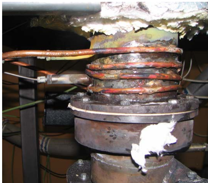
Abbildung 75: Aktive Kühlung des Vergaserrohres
