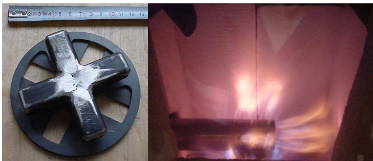
Abbildung 43: Primärluftkreuz (links) und Blick in Brennkammer (rechts)
