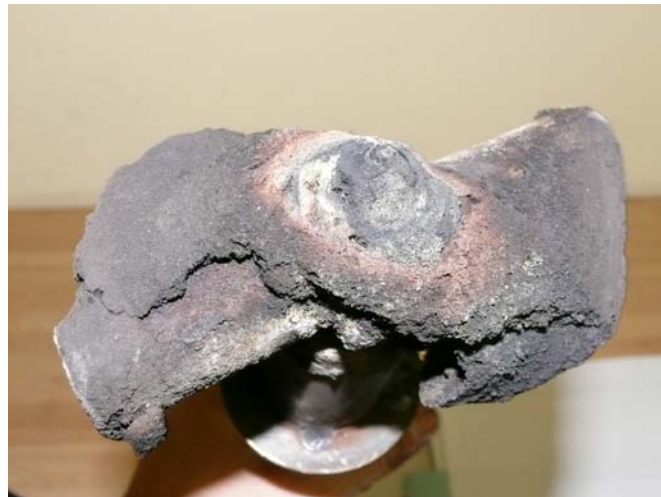
Abbildung 119: Primärluftkreuz mit zwei Luftverteilungsarmen
