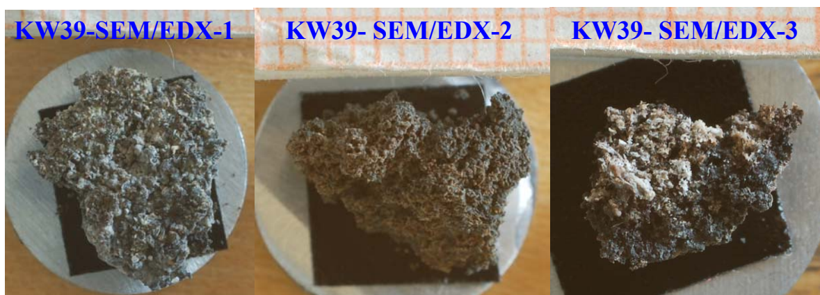
Abbildung 73: Bilder der untersuchten versinterten Ascheproben aus KW39
