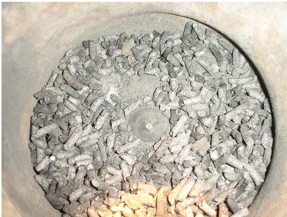
Abbildung 155: Blick auf das Brennstoffbett und das Primärluftkreuz nach Betrieb von oben
