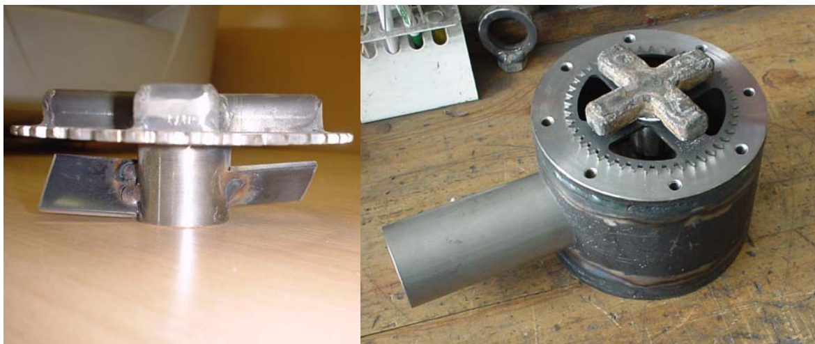
Abbildung 54: Primärluftkreuz mit Rührern (links) und Drehvorrichtung (rechts)
