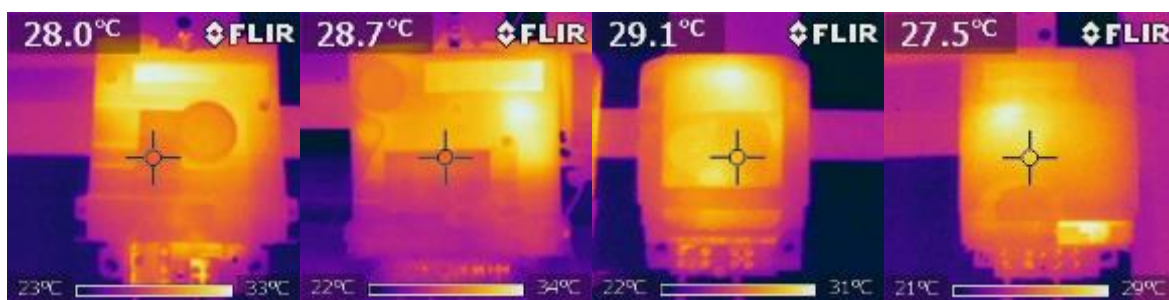
Abbildung 73: Thermobilder der sich am stärksten erwärmenden Smart Meter bei Dauerbetrieb @ 165 V Unterspannung (von links beginnend: Typ 1:Siemens AMIS TD-3512 1 Ph; Typ 2:Siemens AMIS TD-3511 3 Ph; Typ 3: Landys+Gyr E350 (ZCF 120) 1 Ph; Typ 4: Echelon 83331-1/VAD 1 Ph)
