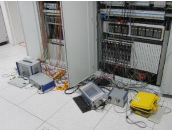
Abbildung 86: Messaufbau LLS-Rotes Kreuz Steiermark (Messgeräte)
