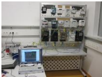
Abbildung 71: Teststand zur Prüfung der Funktion und Einsetzbarkeit der verschiedenen Smart Meter Typen für ein „Smart Emergency Grid“
