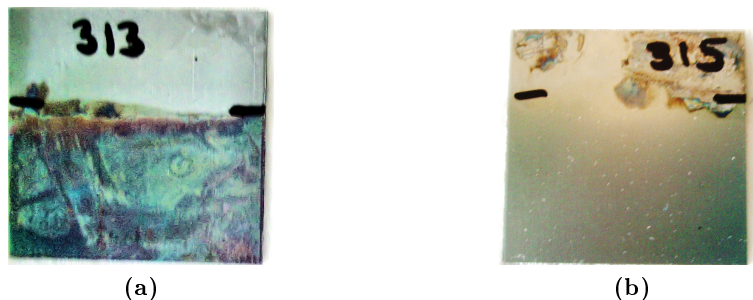
Abbildung 6.23: Optische Färbung von Ti-6Al-4V (a) in \text{NaOH}/\text{CuSO}_4 \cdot 5\text{H}_2\text{O} vorbehandelt wurde, t = 20 min, T = 90 °C (b) nach der Zinkat/Chromat-Behandlung, t = 6 min, T = 90 °C
