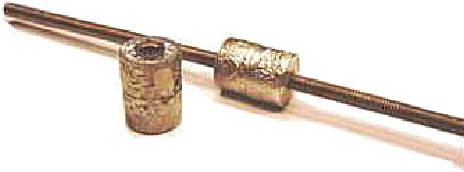
Abbildung 6.17: Verlötete Knopfpaare ( Ti-6Al-4V mit Au/Pd-Ag-Sn beschichtet)
