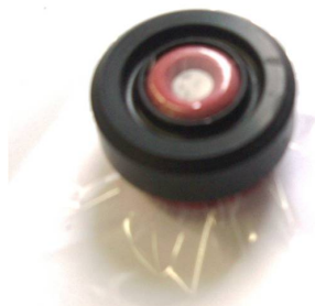
Abbildung 5.4: Flüssigkeitsmesszelle für die XRF
