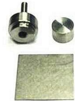
Abbildung 5.1: Verwendete Ti-6Al-4V-Probengeometrien: Flachprobe und zwei Lötknopfformen
