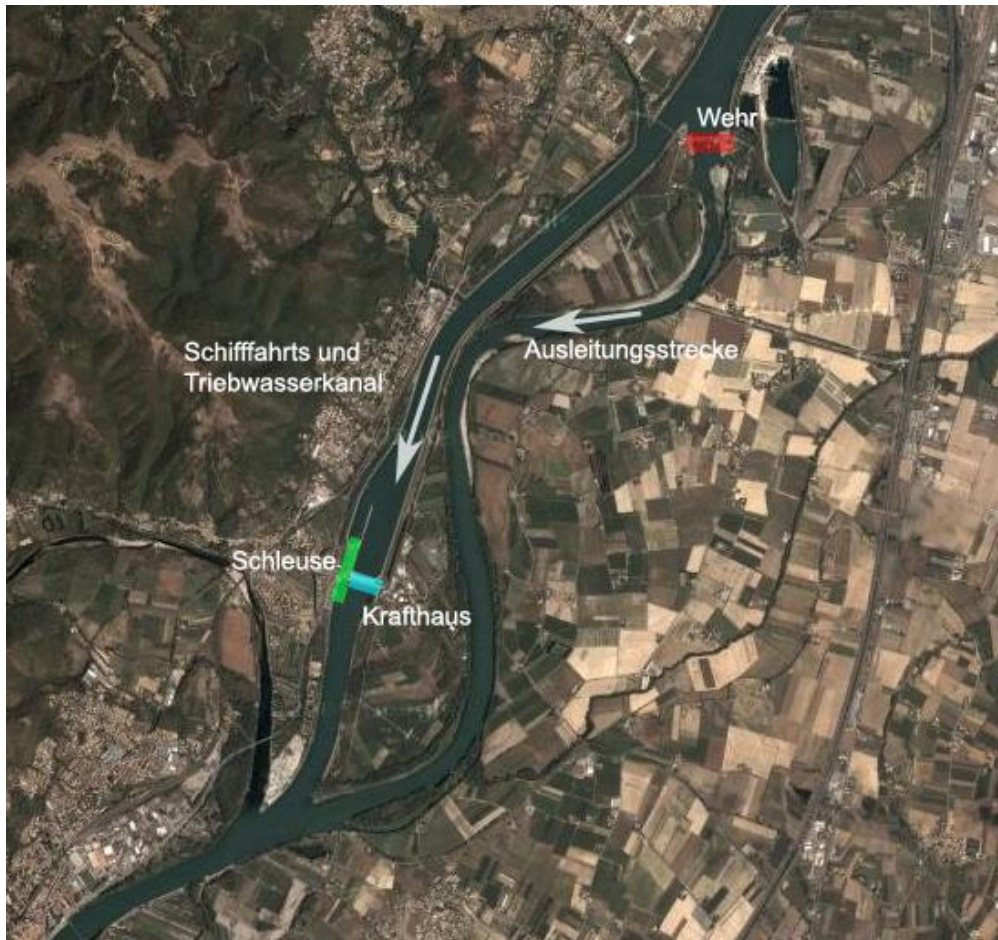
Abbildung 142: Typisches Kraftwerkschema eines Ausleitungskraftwerks an der Rhone. Quelle: Google Maps 2006, eigene Ergänzungen
