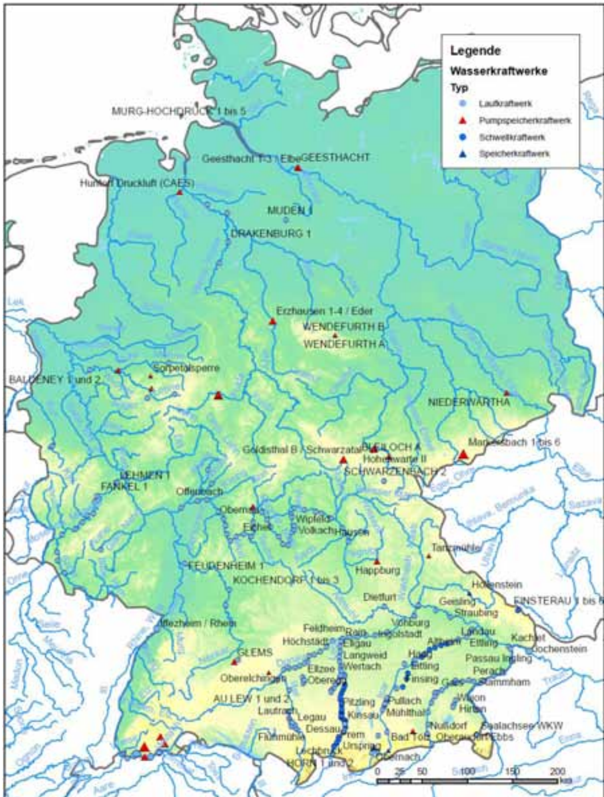
Abbildung 71: Wasserkraftwerke in Deutschland mit einer Leistung über 5 MW, Daten: institutsinterne Datenbank, eigene Darstellung
