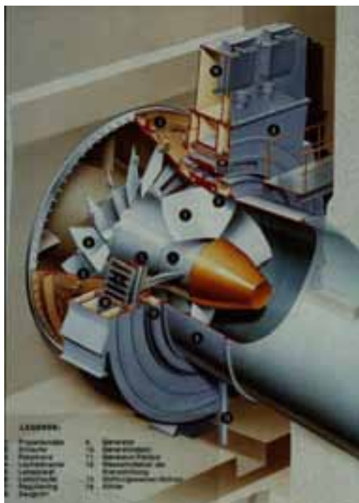
Abbildung 20: Schnitt-Darstellung einer Straflo-Turbine (Kraftwerke Augst AG, 2009)
