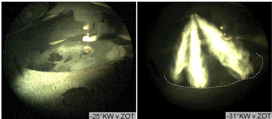
Abbildung 6.11: Endoskopieaufnahmen bei  $n=1200$  1/min,  $w_i=0,25$  kJ/l, EOI<sub>2</sub> = -30 °KW v. ZOT, Spray V2 und Kolben K2
