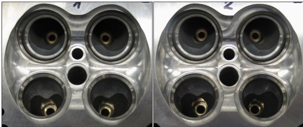
Abbildung 7.6: Brennraum mit Doppelmasking (links) und Einfachmasking (rechts).
