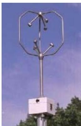
Abbildung 11: Symbolbild eines Ultraschallanemometer
