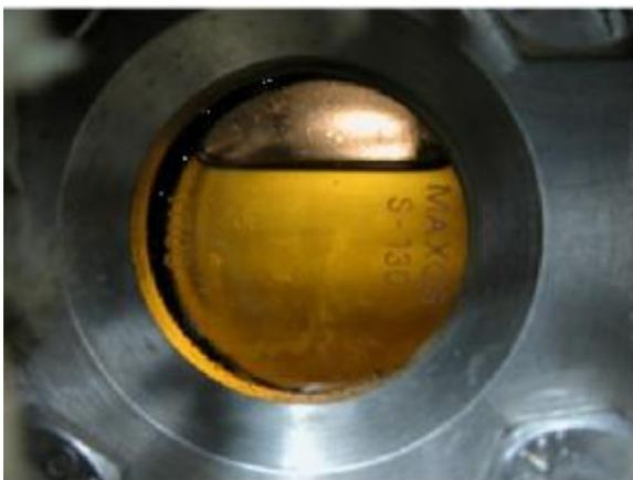
Abbildung 5-12: Phasenverhältnis des Dreikomponentengemisches bei  $T=185^{\circ}\text{C}$  [10]
