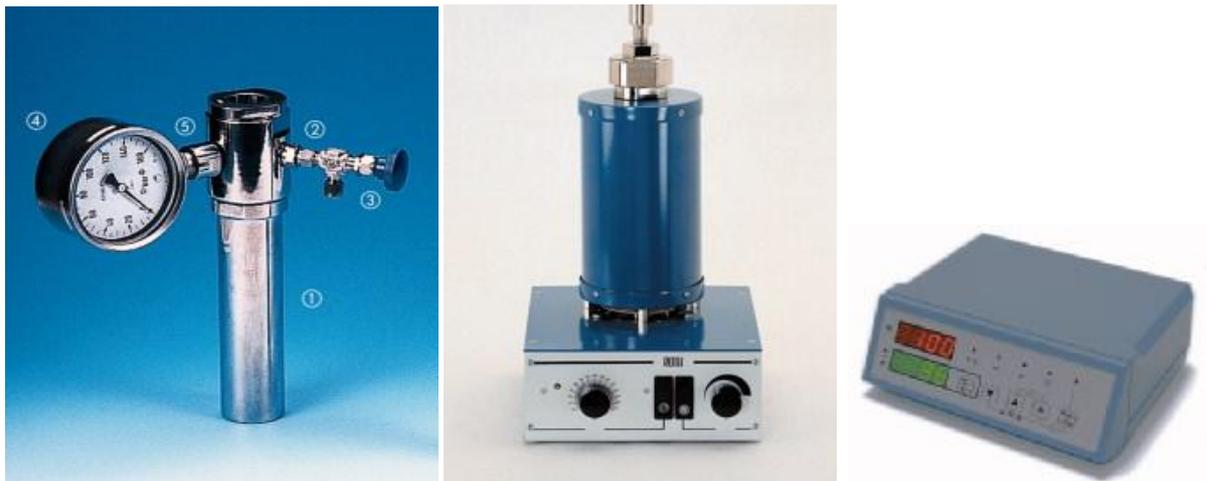
Abbildung 5-1: Autoklav, Heizhaube und Regelung des Apparates [98]
