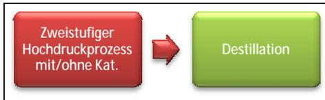
Abbildung 6-6: Logistikdiagramm 2-stufiger Hochdruckprozess mit anschließender Destillation zur Aufreinigung des Produktes
