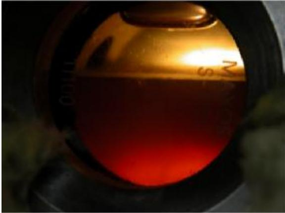
Abbildung 5-4: Phasenverhältnis nach Befüllen bei  $T=30^{\circ}\text{C}$  [10]
