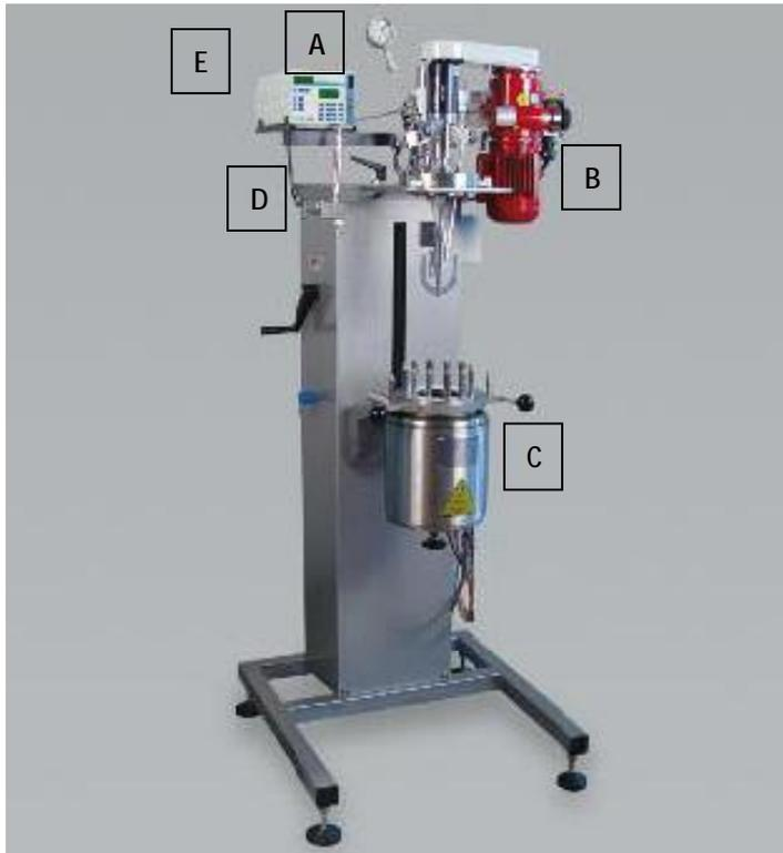
Abbildung 5-2: Laborhochdruckautoklav: A...Manometer, B...Rührantrieb, C...Rührbehälter, D...Probenahmeventil, E...Prozessiereinheit [98]
