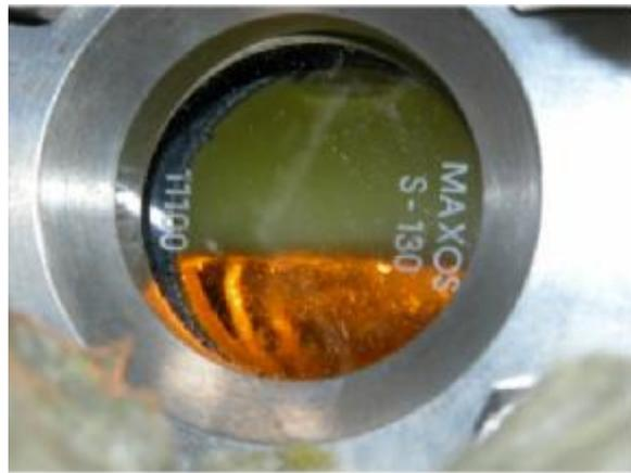
Abbildung 5-9: Trübung während Aufheizvorgang bei  $T=68^\circ\text{C}$  [10]
