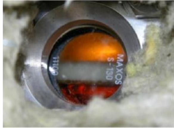
Abbildung 5-5: Phasenverhältnis bei Aufheizung auf  $68^{\circ}\text{C}$  [10]
