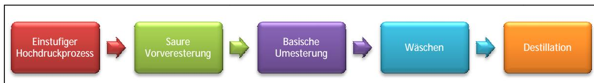
Abbildung 6-4: Logistikdiagramm Biodieselherstellung kombinierter Prozess aus einstufigem Hochdruckprozess und saurer Vorveresterung und basischer Umesterung mit anschließender Destillation zur Aufreinigung des Produktes
