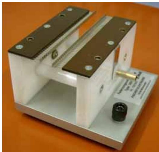
Bild 5.8 Federzungenelektrode zur Bestimmung des Oberflächenwiderstandes gemäß VDE 0303-3
