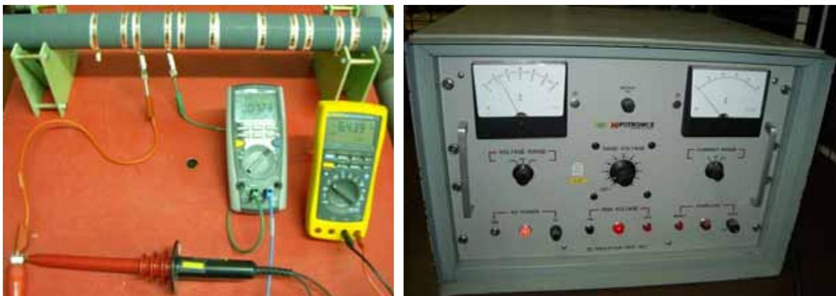
Bild 5.17 Messanordnung von EGS-Bändern am Rundrohr (li.) und HS-Gleichspannungsquelle (re.)
