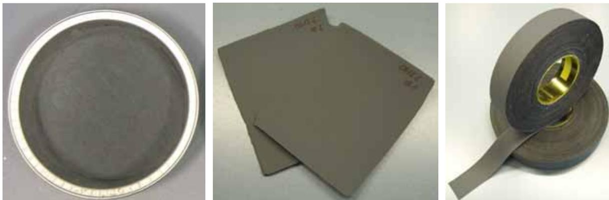
Bild 9.7 Zusammenhang: SiC-Füllstoff – EGS-Composite – EGS-Band
