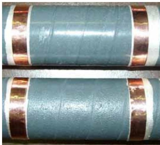
Bild 8.4 EGS-Bandoberfläche nach Verwendung einer Schrumpffolie (oben), ohne SF (unten)
