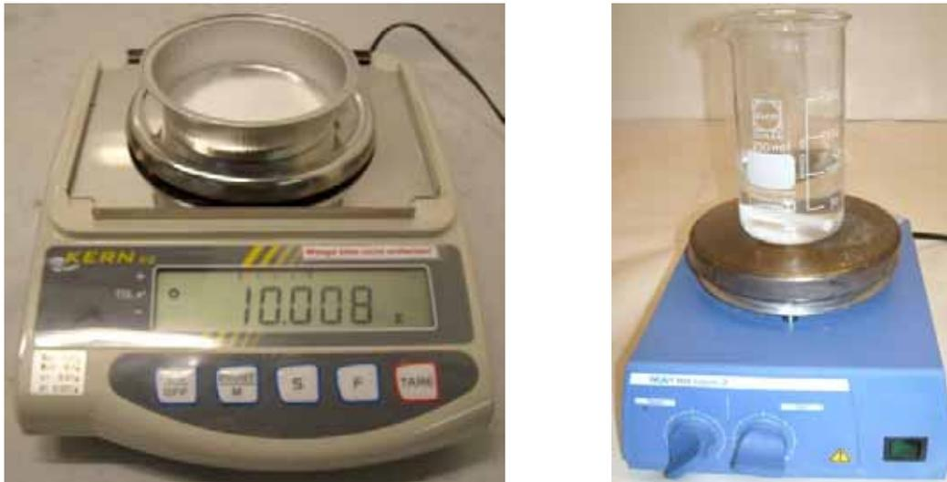
Bild 7.3 Herstellung der Harzgemische: Laborwaage (li.) und Magnetrührer (re.)
