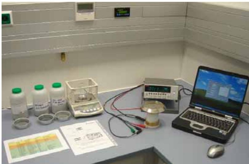
Bild 6.8 Vollklimatisierter Messplatz für Pulvermessungen
