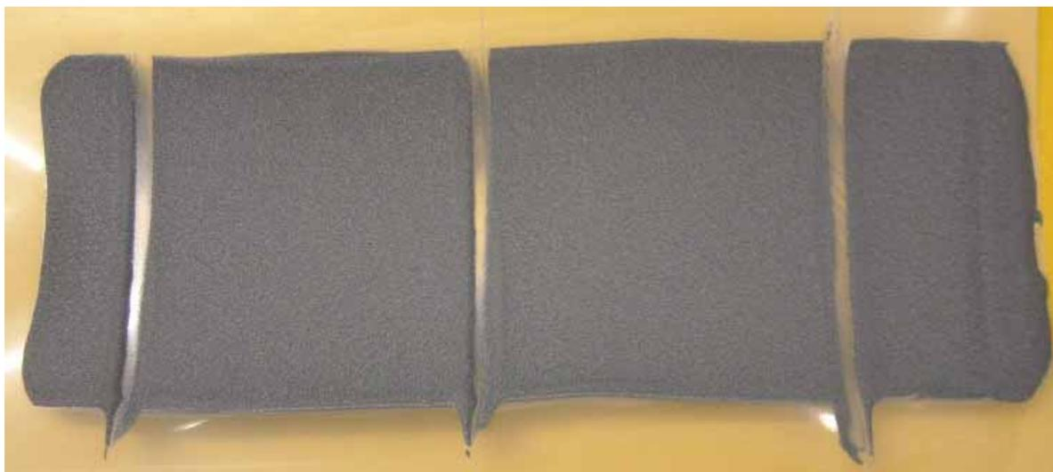
Bild 7.6 EP\_1 Composites nach dem Aushärten auf dem PET-Substrat
