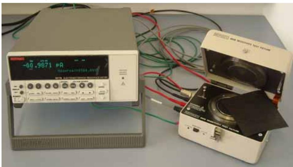
Bild 5.13 Keithley Model 6517B Elektrometer mit Widerstandsmesszelle 8009
