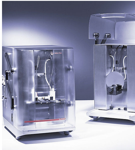
Abbildung 91: Aufbau des Geräts zur Messung des \zeta -Potentials 117
