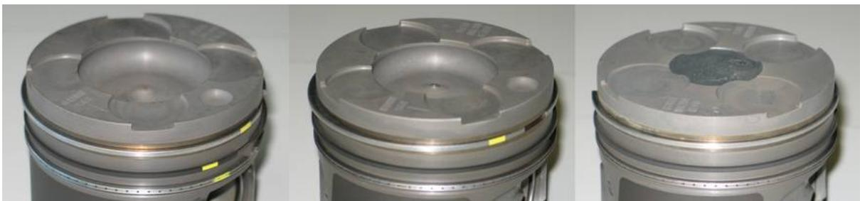
Bild 4–5: Kolben im H<sub>2</sub>-CI-Motor (v.l.n.r.):  $\epsilon = 18$ ,  $\epsilon = 22$ , Halbfertigteil für neue Muldengeometrien
