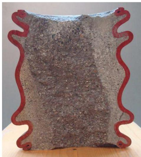
**Abbildung 15:** Nach Versuch durchgeschnittener LSC A2
