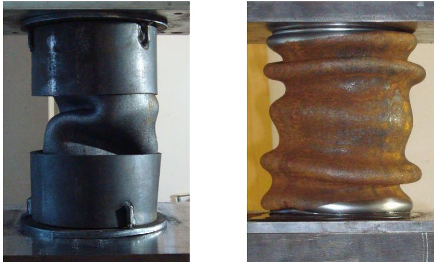
**Abbildung 20:** LSC A2 leer, mit Führungsrohren – LSC A2 gefüllt, ohne Führungsrohre
