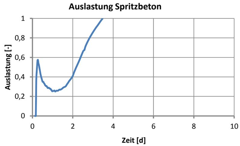
**Abbildung 37:** Spritzbetonauslastung bei 3 Teleskopstauchrohren
