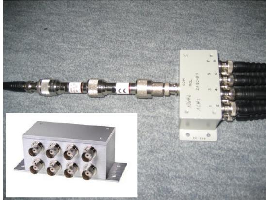
Abbildung 88: Dämpfung und Coaxial Power Combiner ZFSC-8-1
