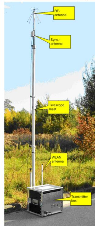
Abbildung 6: Antennen-Masten [SPNMB10]
