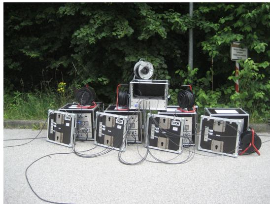
Abbildung 115: Herstellen der Verbindungen zwischen Referenzoszillator und TM5 - TM8
