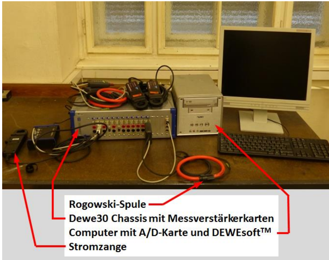
Abbildung 9: Ausrüstung für die Leistungsmessung
