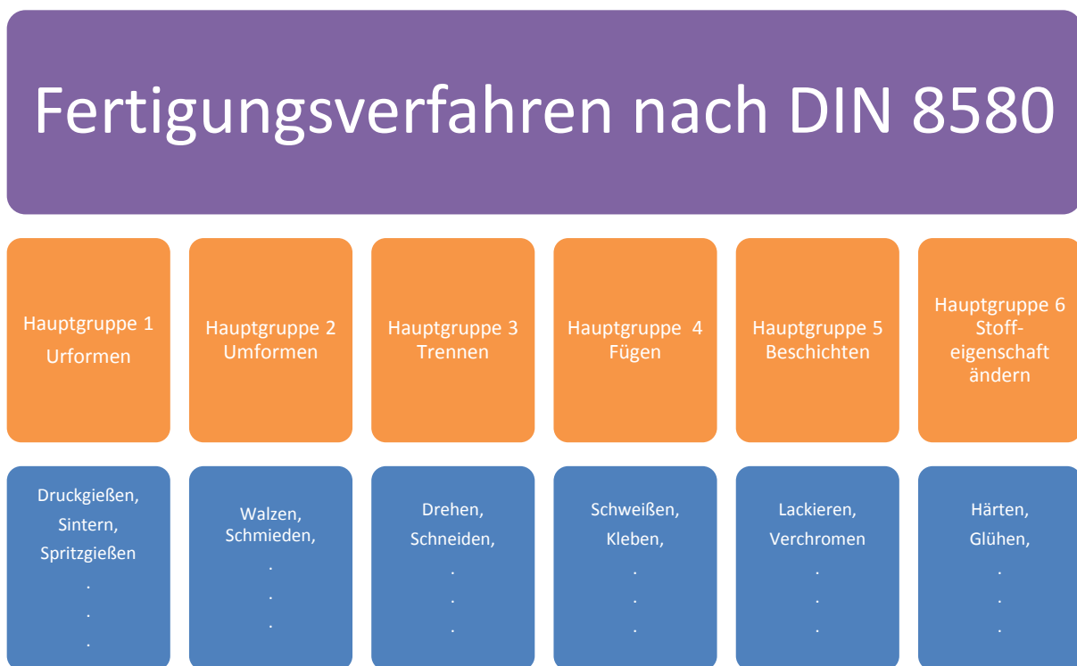
Abbildung 3: Einteilung der Fertigungsverfahren nach DIN 8580
