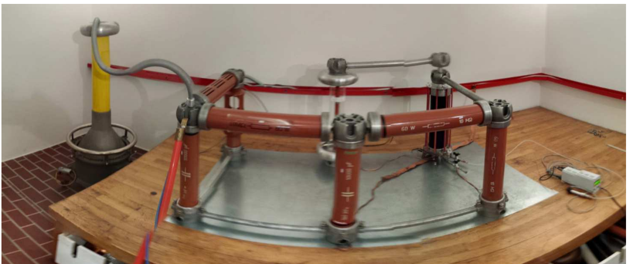
Bild 6.4: Prinzipieller Messaufbau mit Belastungswiderstand
