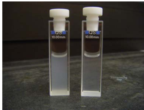
Abb. 4.11: Foto von \text{Y}_2\text{O}_3:\text{Eu} -Nanopartikeln bei 800^\circ\text{C} angelassenen (links) und im Herstellungszustand (rechts), zur Fluoreszenzmessung dispergiert in Ethanol.
