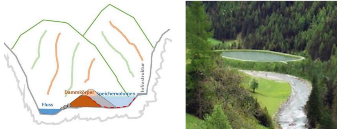
Abb. 14: a) Schemadarstellung eines beengten Talquerschnitts, b) Animation Tagesspeicher Toinig WKW Obere Isel (Der Virgentaler Weg 2013)
