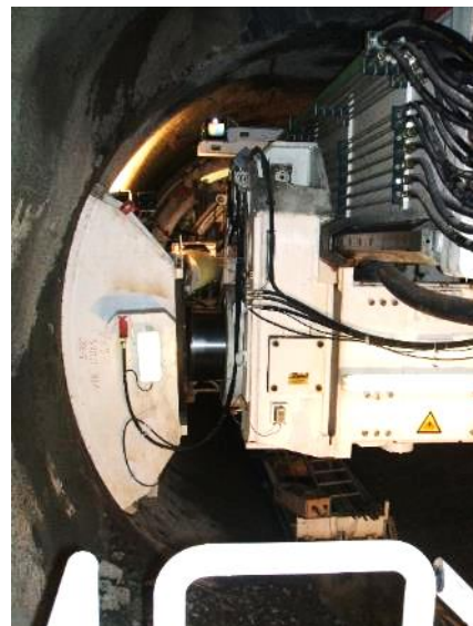
Abb. 18: a) Elisza Jane Gripper-TBM für den TWW des WKW Glendoe (Schadereit 2006), b) Gripperplatte der TBM (Schadereit 2006)
