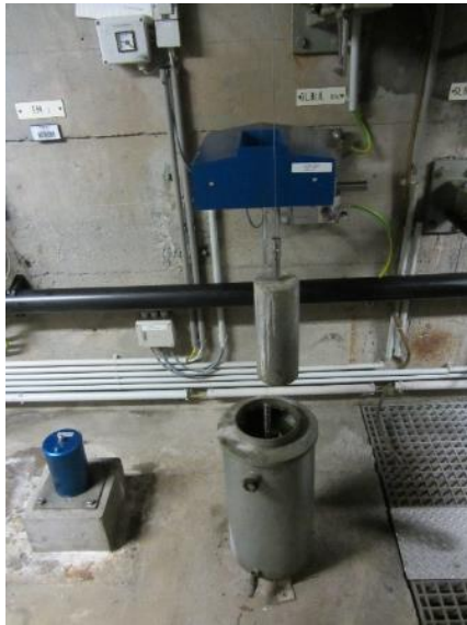
Abb. 8: a) Hängelot der Paalsperre des KW Bodendorf, b) automatische Sickerwassermessung
