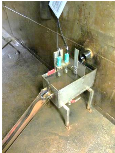
Abb. 8: a) Hängelot der Paalsperre des KW Bodendorf, b) automatische Sickerwassermessung
