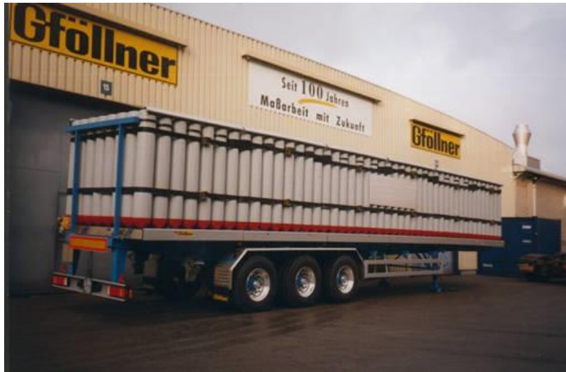
Abbildung 2-4: Trailer für den Transport von gasförmigem Wasserstoff [9]
