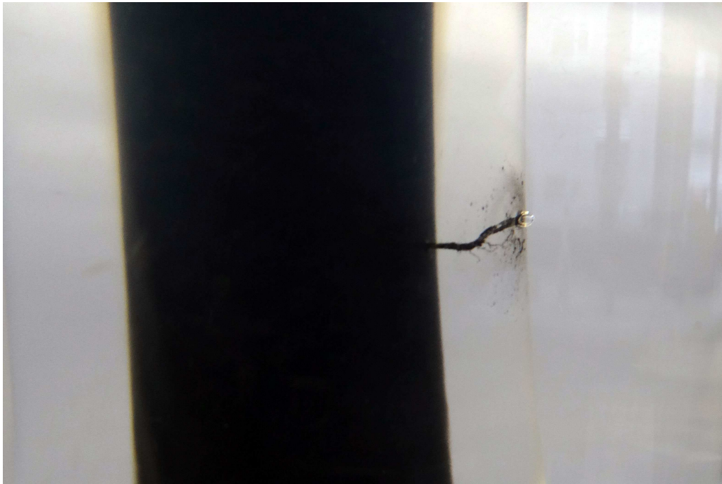
Abbildung 6.9: Durchschlagskanal im transparentem Polyethylen (Probe 1-12-09-A3-b)
