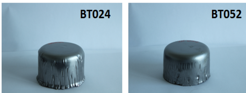
Abbildung 5.5: BT024 (D): DC04, d = 210 \text{ mm} , t = 1,3 - 1,4 \text{ mm} , 180 \text{ kN} , mit Distanzen von 3 \text{ mm} tiefgezogen, deutliche Faltenbildung; BT052 (B): DC04, d = 180 \text{ mm} , t = 1,5 \text{ mm} , 180 \text{ kN} , ohne Distanzen tiefgezogen, es sind kaum Falten zu erkennen
