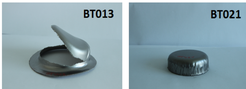
Abbildung 5.6: BT013 (A): DC04, d = 150 \text{ mm} , t = 1,5 \text{ mm} , 180 \text{ kN} Blechhalterkraft, keine Distanz - Riss; BT021 (A): DC04, d = 150 \text{ mm} , t = 1,5 \text{ mm} , 180 \text{ kN} Blechhalterkraft, 1,0 \text{ mm} Distanz - Durchzug mit einer Ziehtiefe von 31,2 \text{ mm}
