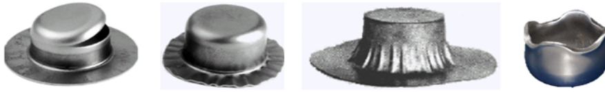
Abbildung 3.12: Fehler beim Tiefziehen: Riss im Boden, Falten 1. Ordnung, Falten 2. Ordnung, Zipfelbildung [15]
