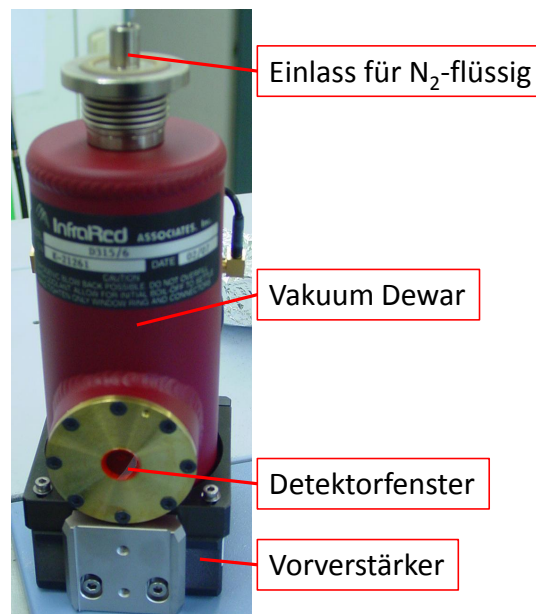
Abbildung 2.2: MCT Detektor des Bruker Spektrometers.
