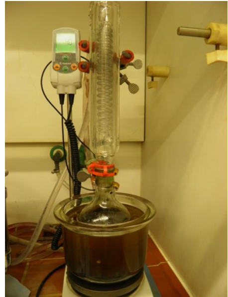
Abbildung 25: Versuchsaufbau bei der In Situ-Umesterung
