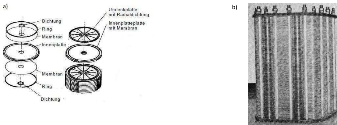
Abbildung 13: a) Aufbau Plattenmodul, b) fertiges Plattenmodul, [6]
