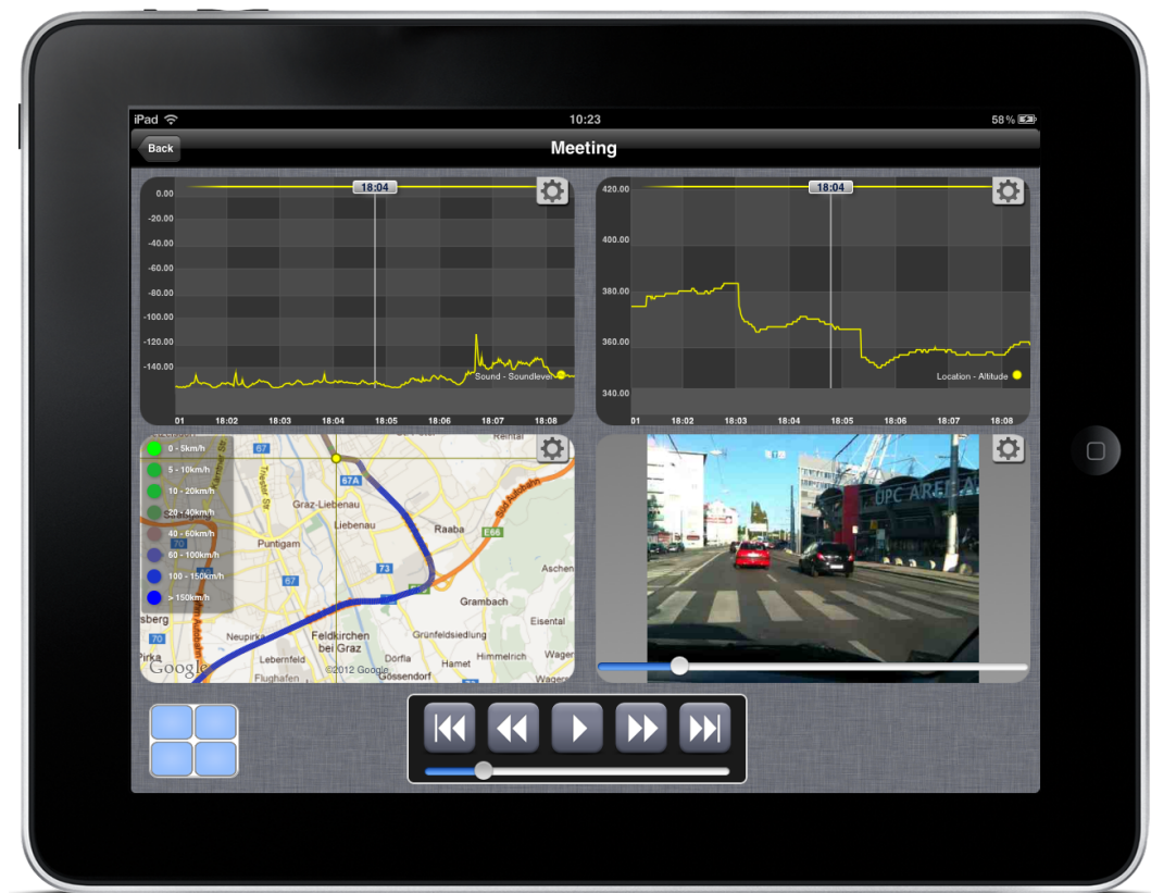
Abbildung 5.11: Synchronisation der Visualisierungen von Höheninformationen, Lautstärke-Levels, Bild und Geo-Positionsdaten am iPad
