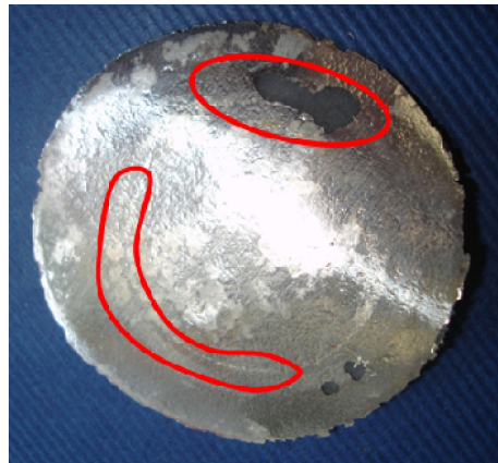
Abbildung 22: Ablösungen der Aluminiumschicht nach Entnahme aus der Permeationskammer (mit Aluminium beschichtetes Polyoxazolin auf Papiersubstrat).
