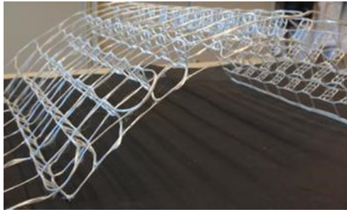
Abbildung 4.6: Dreidimensionale Textilbewehrungen mit eindimensionaler Krümmung [30]
