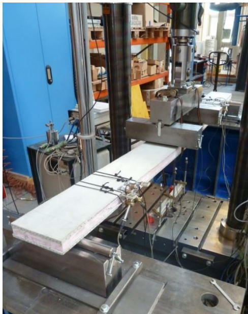
Abbildung 4.8: Vierpunkt-Biegeversuch an einem Sandwichelement [33, S. 101]
