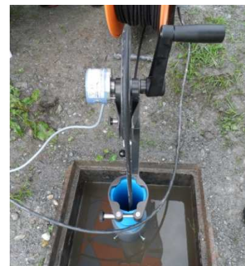
Abb. 40 Temperierung der Sonde
