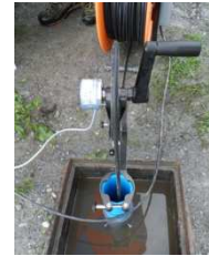
Abb. 36 Verbindung Kabelrolle - Konverter
