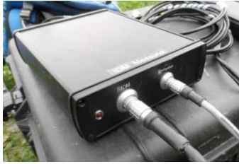
Abb. 31 Verbindung Kabelrolle/Winde - Konverter
